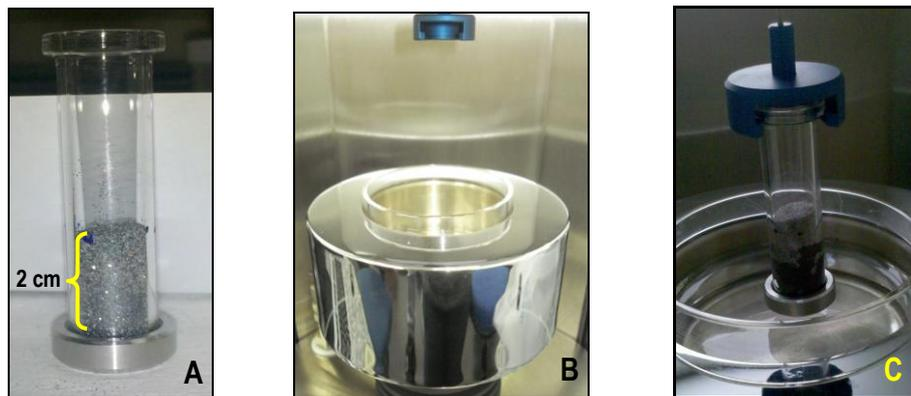
Figura 2 - (A) Amostra no tubo capilar (marcação da altura 2 cm); (B) Cubeta onde é colocado o fluido para a análise; (C) Ascensão capilar em andamento na amostra.
