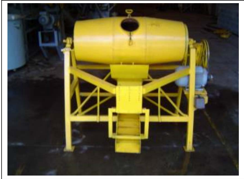
Figura 1 – Tambor amalgamador, existente no CETEM, para amalgamação de ouro.
