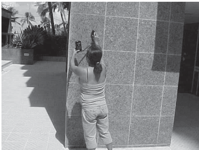
Figura 5 – medição do brilho em revestimento pétreo
