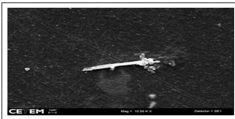
Figura 6. Imagem de fibra semelhante à anfíbólio, presente no filtro de Teflon (2,5 \mu\text{m} ) –Análise ao MEV.
