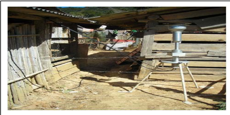
Figura 5. Amostrador Dicotômico – acessório de captação de particulado (fora da oficina da Sra. Dionísia).
