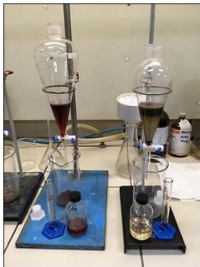
Figura 1: Vista geral dos ensaios de separação por líquido denso.
