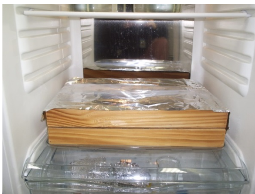
Figura 14. Ensaio de toxicidade aguda com Daphnia similis em Câmara de B.O.D. com bandeja de madeira coberta com alumínio para proporcionar escuro às amostras.
