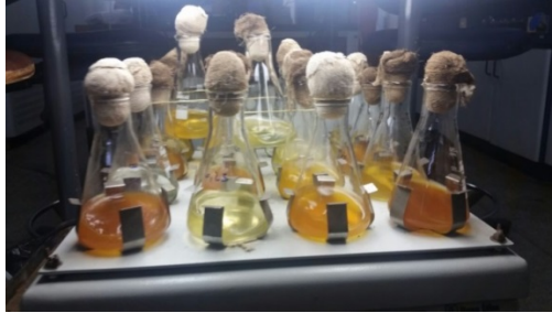
Figura 15. Ensaio de toxicidade crônica com Raphidocelis subcapitata em mesa agitadora orbital.
