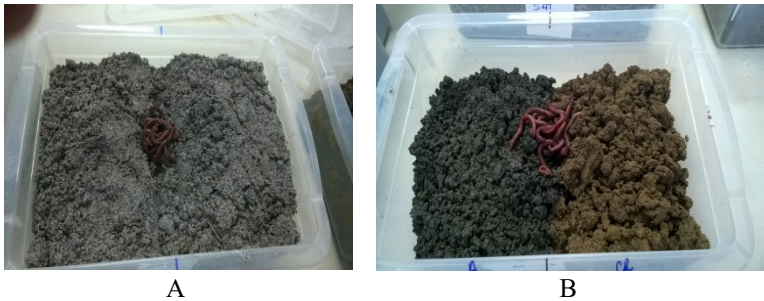
Figura 9. Aspecto do ensaio de fuga com Eisenia andrei com recipiente com minhocas recém-introduzidas: A – solo artificial tropical (SAT) e B – solo natural.
