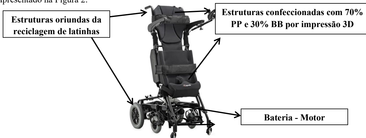
Figura 2: Protótipo da cadeira de rodas elevatória contendo resíduo de Mármore Bege Bahia.
