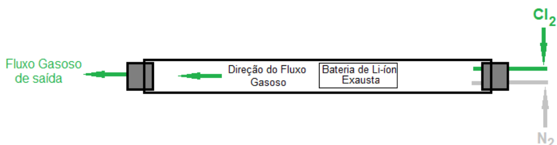
Figura 1: Desenho esquemático do reator de alumina onde ocorre a formação dos cloretos dos metais constituintes das baterias de íons de lítio.
