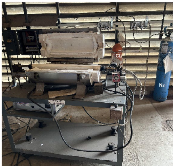
Figura 2: Sistema reacional utilizado nos testes de extração de lítio de baterias de íons de lítio esgotadas.
