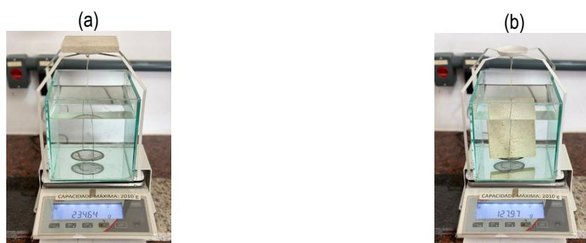
Figura 1. Pesagem das rochas aglomeradas: (a) massa saturada e (b) massa submersa.
