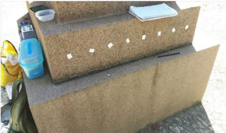
Figura 12. Pontos de medição utilizando o Pundit, seguindo o método do line scan na parte traseira da escultura.
