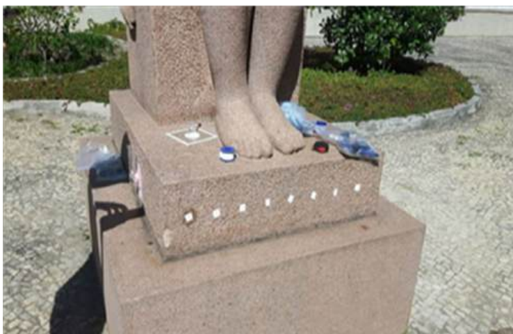
Figura 11. Pontos de medição utilizando o Pundit, seguindo o método do line scan na parte frontal da escultura.
