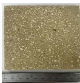
Figura 4: Corpo de prova realizado da composição 50BB1,0/25BB0,5/25BBF/10R.
