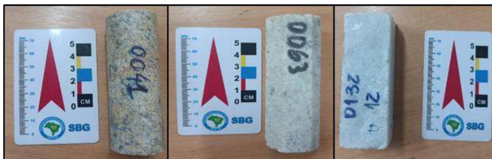
Figura 1: Formatos dos corpos de prova: GRA41 (cilíndrico); GRA63 (prisma octogonal); MAR132 (prisma quadrangular).
