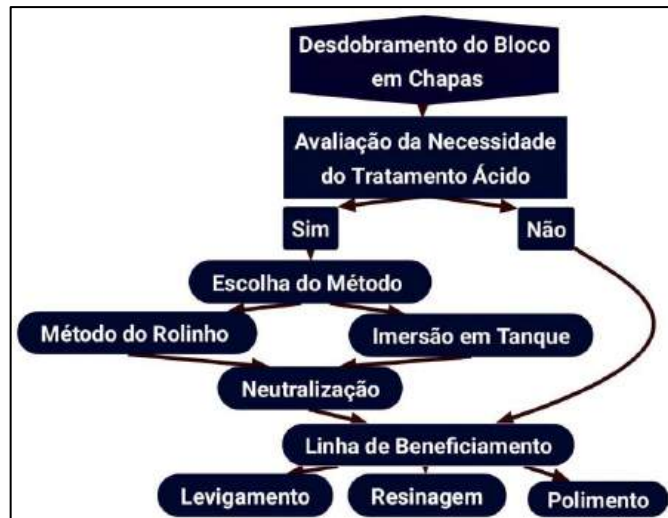
Figura 1: Fluxograma que ilustra o processo de beneficiamento das rochas ornamentais com tratamento de superfície.
