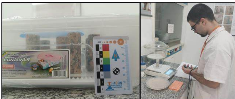
Figura 3: Ensaio das medições de absorção de água por capilaridade.
