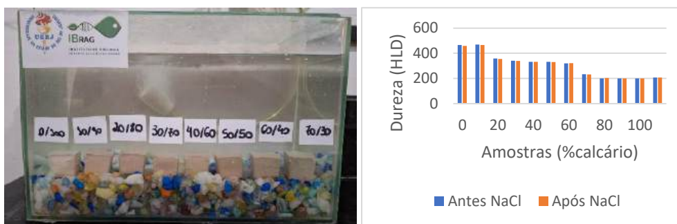
Figura 2: Ensaio em aquários UERJ (água salgada 35% p/v). Figura 3: Dureza (HLD).
