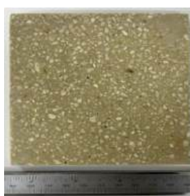
Figura 4: Corpo de prova realizado da composição 50BB1,0/25BB0,5/25BBF/10R.
