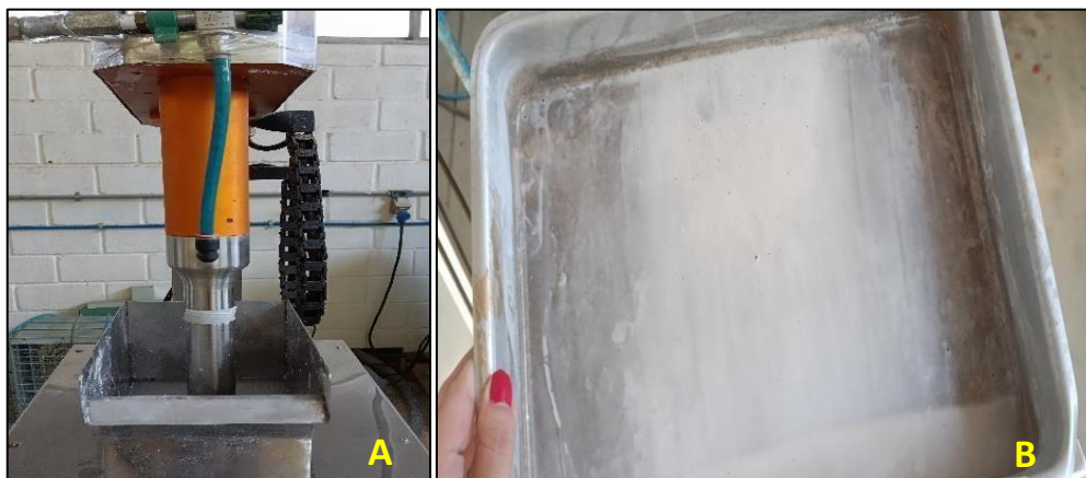
Figura 2: Coluna de flotação (A) utilizado na pesquisa e material obtido no processo (B).
