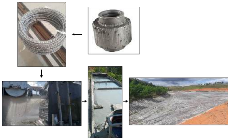
Figura 4. Esquema de produção e deposição de resíduos finos gerados por tear multifio diamantado.
