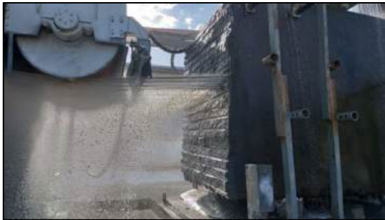
Figura 3. Detalhe do processo de serragem com tear multifio diamantados.
