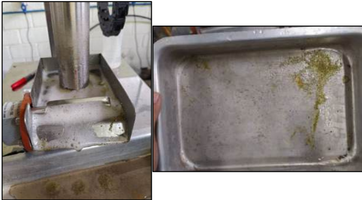
Figura 12. Processo de flotação em célula de 1 L à esquerda e concentrado à direita.
