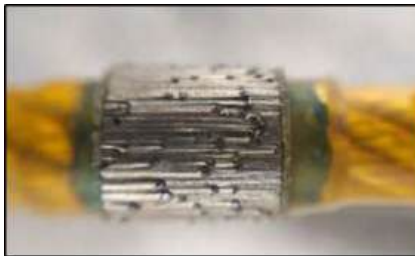
Figura 2. Fotografia em detalhe de uma pérola diamantada que compõe o fio para corte de rochas.
