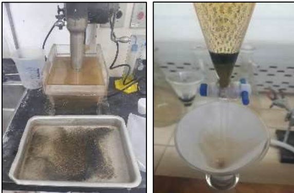
Figura 5. Flotação do resíduo e concentração em meio denso.
