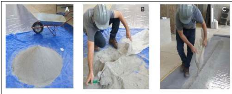
Figura 9. Construção da pilha cônica (A), fracionamento (B) e distribuição do resíduo na pilha longitudinal (C).
