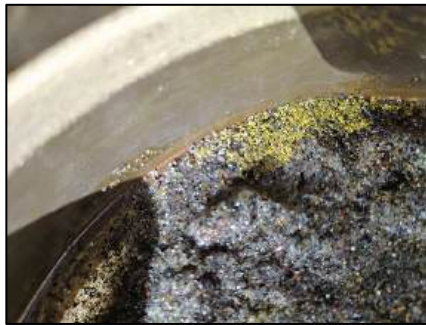
Figura 11. Concentração dos diamantes na peneira 48 mesh.
