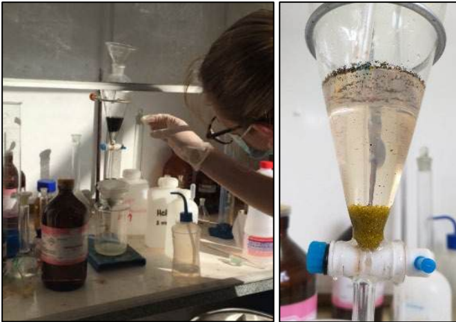
Figura 16. Ensaio de meio denso para concentração do diamante.
