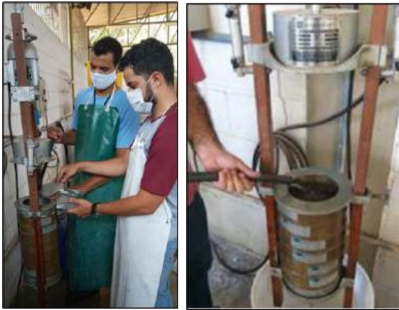
Figura 10. Classificação do resíduo em peneirador de coluna.
