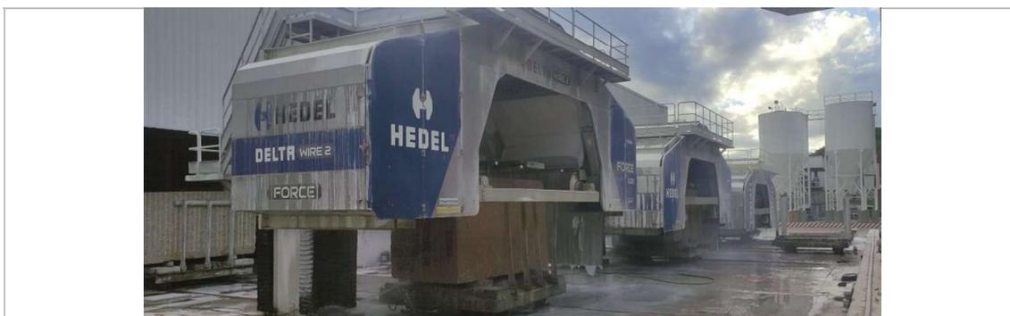
Figura 1. Exemplo de tear multifio, modelo *Delta Wire 2*.
