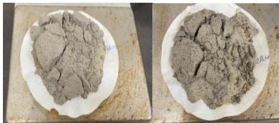
Torta úmida (rejeito arenoso) (a)
