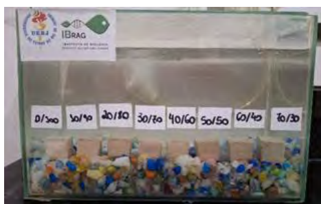
Figura 2: Ensaio em aquários UERJ (água salgada 35% p/v).
