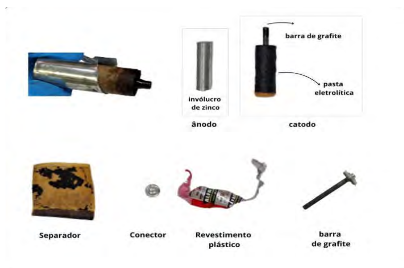
Figura 1: Componentes da pilha ALFACELL
