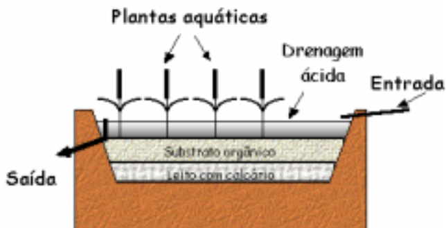
Figura 9: Corte transversal esquemático de uma área alagada ( wetland ) aeróbia típica (FLS).
