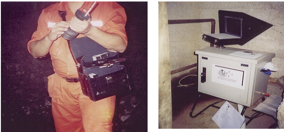
Figura 8.10 Medición de gases con AUGER GAS TESTER II y de polvos con CAV-A/HF
