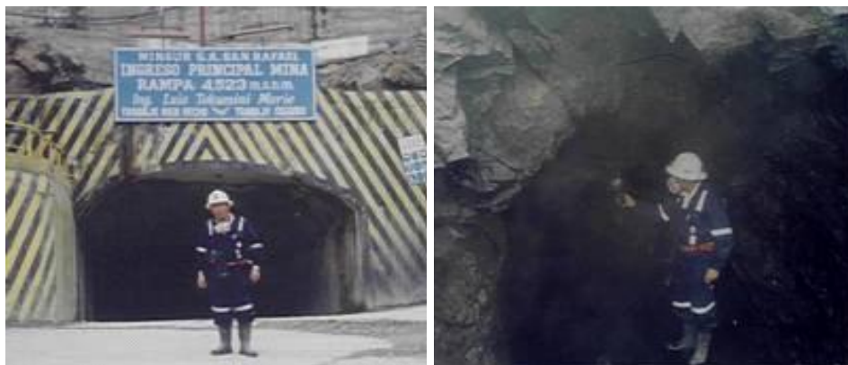
Figura 9.8 Rampa 523 y mediciones de los parámetros aerodinámicos de la atmósfera subterránea de la mina de San Rafael
