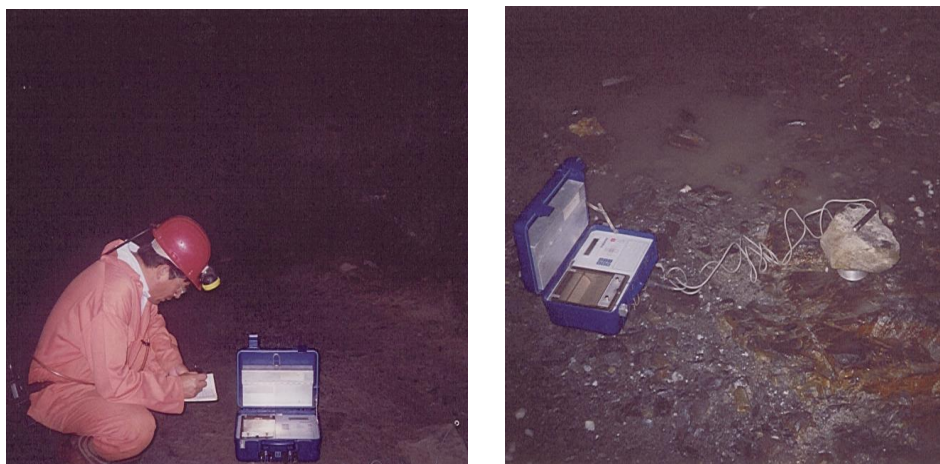
Figura 8.62 Mediciones de la velocidad de propagación de las ondas P por la detonación de explosivos con sismógrafo BlastMate II DS-277 InstanTel, en los tajeos de la mina Panasqueira
