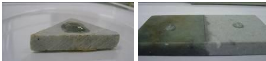
Figura 7: Efeito da água em superfície hidrofugada e não hidrofugada.
