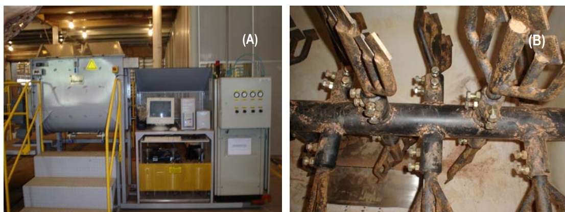
Figura 2 – Imagem da unidade piloto do biorreator (a) e das pás agitadoras no seu interior(b)
