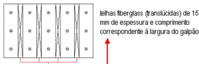
Figura 4 – Desenho esquemático das telhas translúcidas.
