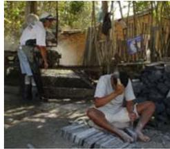
Figura 1 – Operação de deslocamento. Ao fundo, máquina utilizada para transformação das lajes em blocos.
