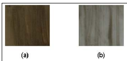
Figura 3. Revestimentos cerâmicos com pigmento de óxido de cobre e moscovita utilizando frita composta de feldspato (frita 1). (a) queima a 900°C; (b) queima a 1.200°C.
