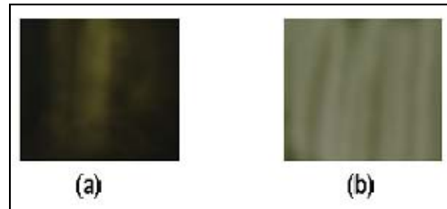
Figura 4. Revestimentos cerâmicos com pigmento de óxido de cobre e manganês utilizando frita composta de feldspato, ácido bórico, óxido de magnésio e de zircônio (frita 2) na temperatura de 1.200°C (a) pigmento sem moscovita; (b) pigmento com moscovita.
