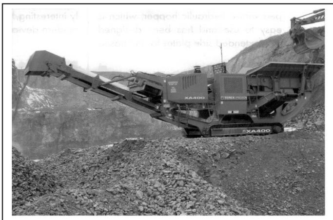
Figura 16 – Unidade móvel compacta incluindo britagem e peneiras.
