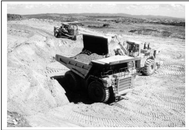
Figura 12 – Sistema carregadeira frontal/caminhão usualmente empregado em pedreiras com trator dando suporte em operações auxiliares.
