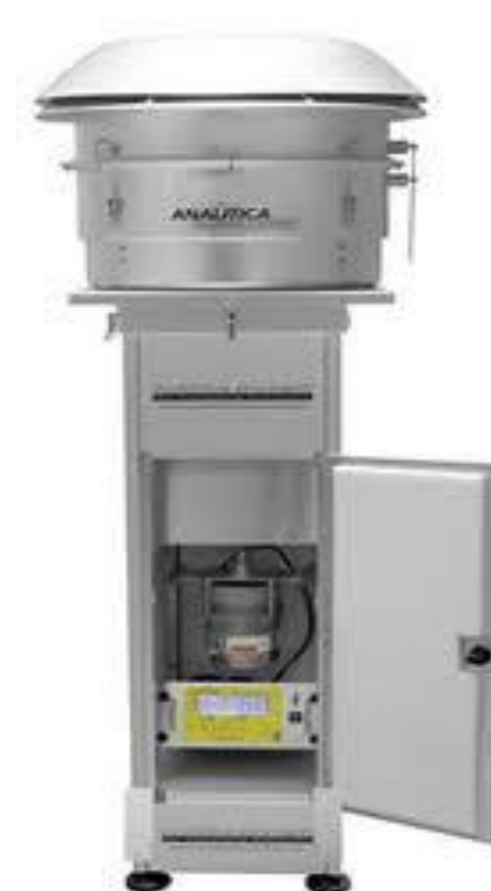
As amostragens foram feitas por Amostradores de Grandes Volumes (High Volume Sampler).
