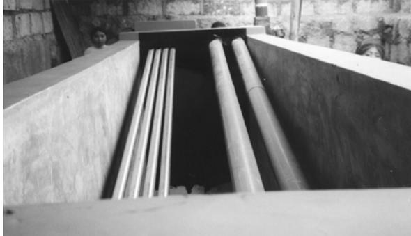
**a.4) La tasa de recolección,** de Fibra de vidrio, enlucido internamente con anticorrosivos, que recibe el mercurio líquido producto de la condensación y que periódicamente se descarga.
