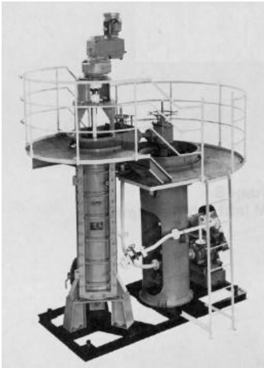
**Figura 9 - Moinho de torre KW-3 com baixa velocidade [31]**
