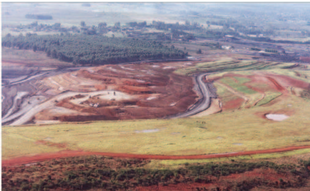
Figura 12 – Desenvolvimento da lavra de carvão (esquerdacentro) na Mina do Recreio, Rio Grande do Sul, processo de recuperação em andamento (direita e plano inferior) e área reflorestada (topo-esquerda)
