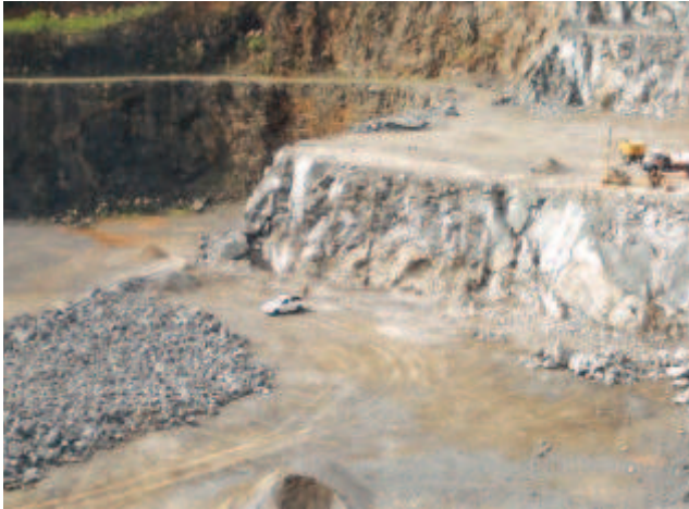
Figura 6 – Altura de bancada em pedreira de basalto no Rio Grande do Sul. Observa-se a incompatibilidade da altura de bancada e porte de equipamentos de perfuração, carregamento e transporte
