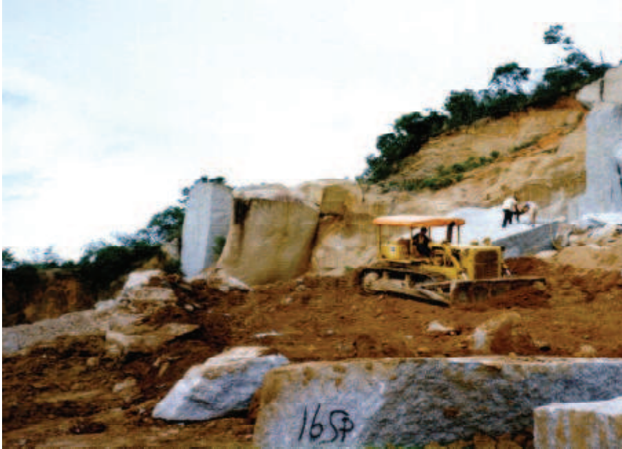
Figura 7 – Lavra de rochas ornamentais em matacões, Rio Grande do Sul. Pedreira desenvolvida sem planejamento e pouco mecanizada
