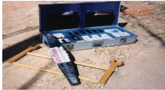
FIGURA 3 - RAMAC/GPR, com todas os seus acessórios, utilizados neste trabalho
