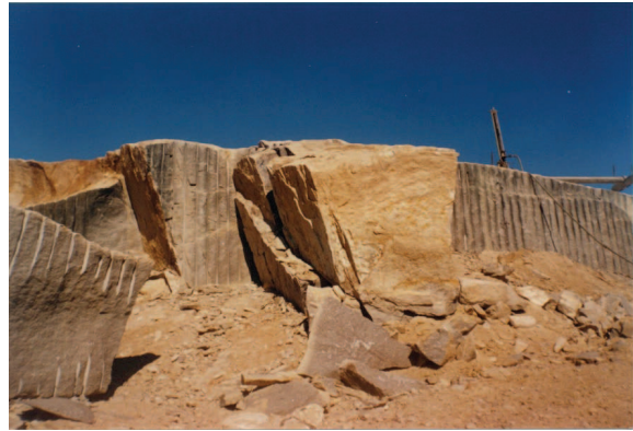
FIGURA 3 - Detalhes do fraturamento vertical e horizontal na área da pedreira
