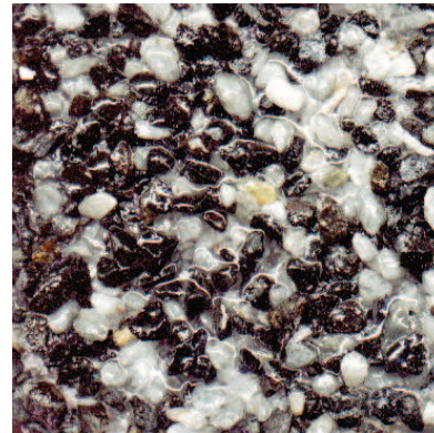
FIGURA 02 - Placas de resina com associação de rejeitos de caulim e outros resíduos minerais
