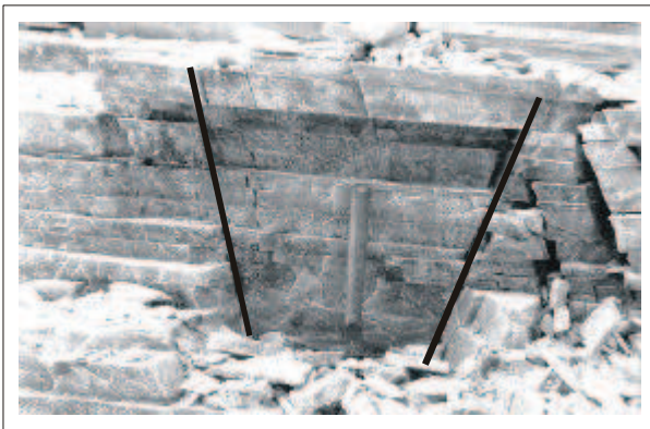
Fotografia 07: Famílias de fraturas 01 e 02 nos quartzitos do Centro Produtor de São Thomé das Letras na região de São Thomé das Letras (MG).
