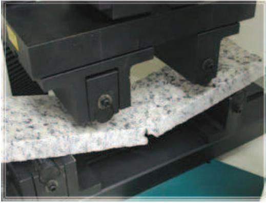
FIGURA 6 – Detalhe de corpo-de-prova, obtido a partir de rocha beneficiada, rompido após a aplicação de esforços.
