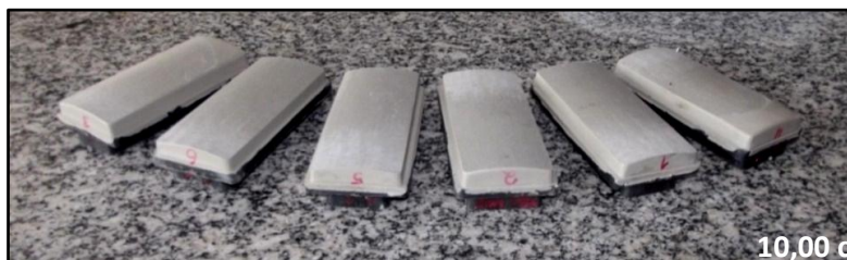
Figura 1: Rebolos abrasivos confeccionados com resina vegetal e SiC.
