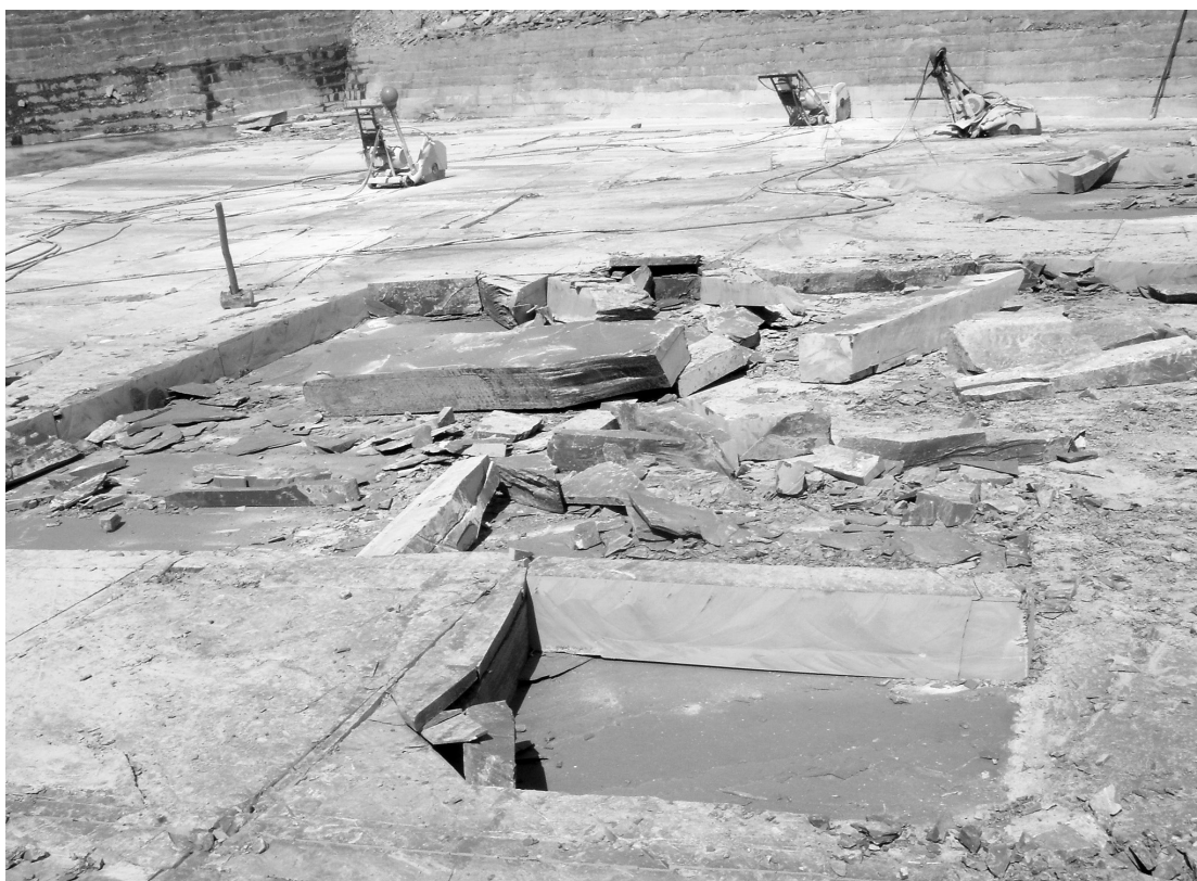
Figura 18 - Aspecto de ardósia em extração em lavra em Papagaios (MG). Foto: M.H.B.O. Frascá.
