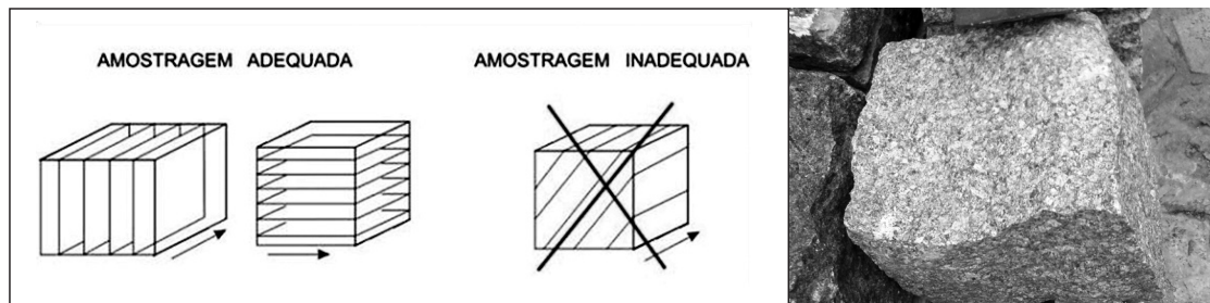
Figura 20 - Ilustração orientativa para a amostragem (bloquetes) de rochas com estruturação (gnaises), com a seta indicando o sentido da estrutura. À direita, exemplo de “bloquete”. (Desenho: Fabiano C. Navarro). Foto: M.H.B.O.Frască.
