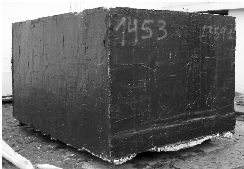
Figura 2 - Bloco Estruturado (Envelopado). Foto: CETEM/MCTI, 2011.
