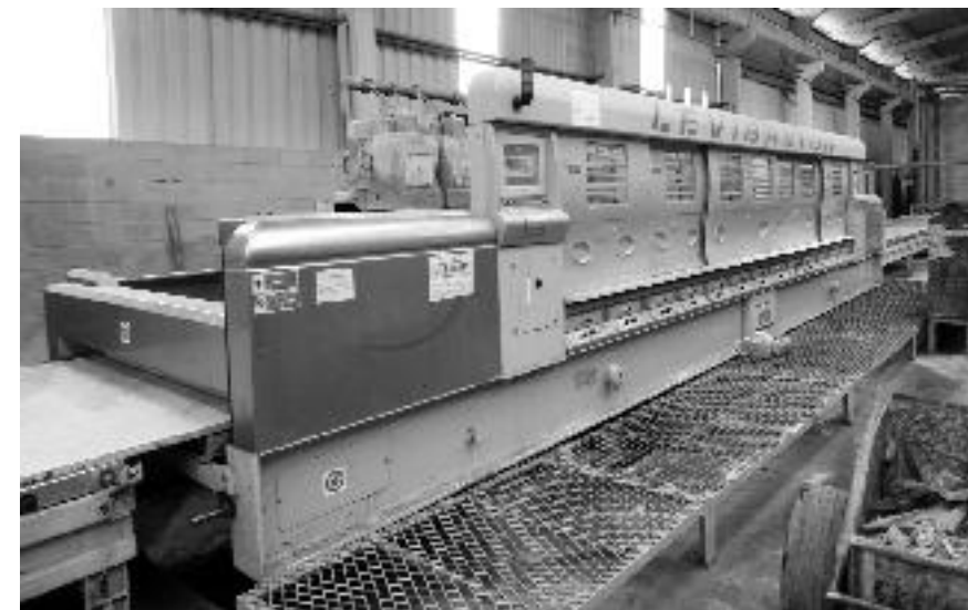
Figura 58 - Modelo de politriz automática multicabeça. Foto: CETEM/MCTI, 2011.
