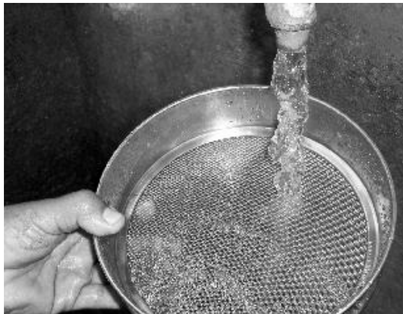
Figura 18 - Granalha ativa retida após a passagem da lama sobre uma peneira de 0,4 mm de abertura. Foto: CETEM/MCTI, 2013.
