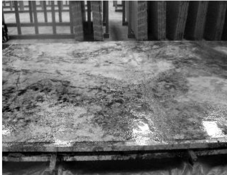
Figura 43 - Vista de chapa de granito resinada e estucada. Foto: CETEM/MCTI, 2009.
