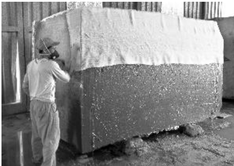
Figura 9 - Processo de envelopamento de bloco de rocha ornamental. Foto: CETEM/MCTI, 2011.
