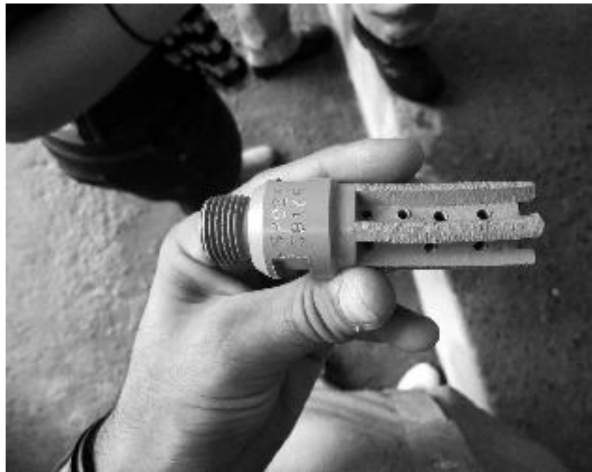
Figura 84 - Ponta gráfica diamantada para execução de furos em peças de marmoraria. Foto: CETEM/MCTI, 2010.
