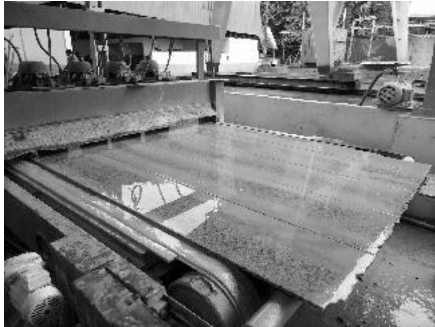
Figura 72 - Chapa subdividida em fitas em cortadeira multidisco. Foto: CETEM/MCTI, 2012.
