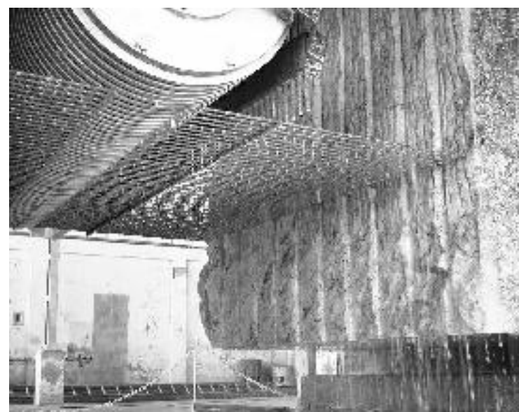
Figura 29 - Detalhe dos fios diamantados cortando um bloco de granito. Foto: CETEM/MCTI, 2011.
