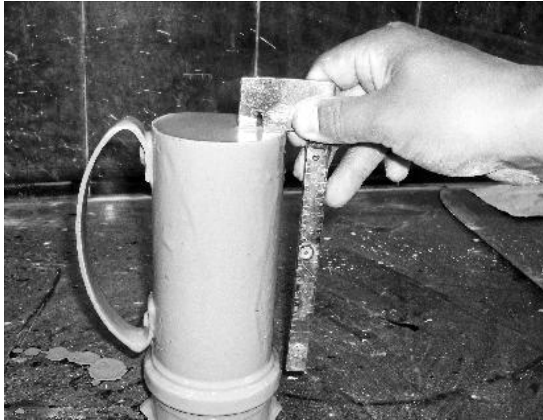
Figura 17 - Medição da viscosidade através de régua utilizada pelo setor. Foto: CETEM/MCTI, 2013.
