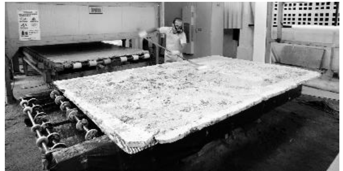
Figura 46 - Forno de desumidificação para aplicação de resina no processo de telagem. Foto: CETEM/MCTI, 2011.
