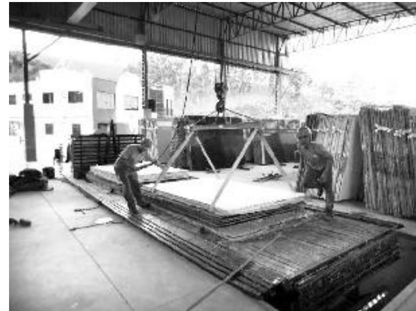
Figura 70 - Processo de carregamento de chapas em caminhão. Foto: CETEM/MCTI, 2012.
