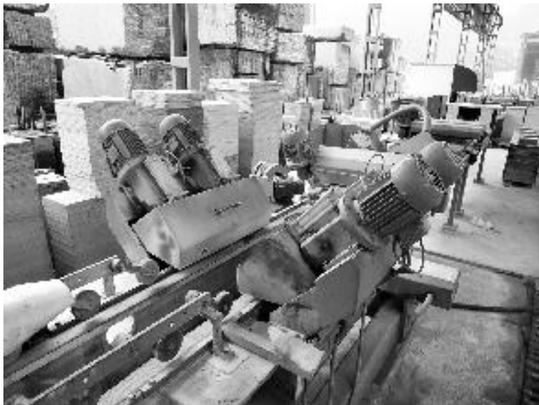
Figura 77 - Bisotes e fresa utilizados no acabamento dos ladrilhos. Foto: CETEM/MCTI, 2010.
