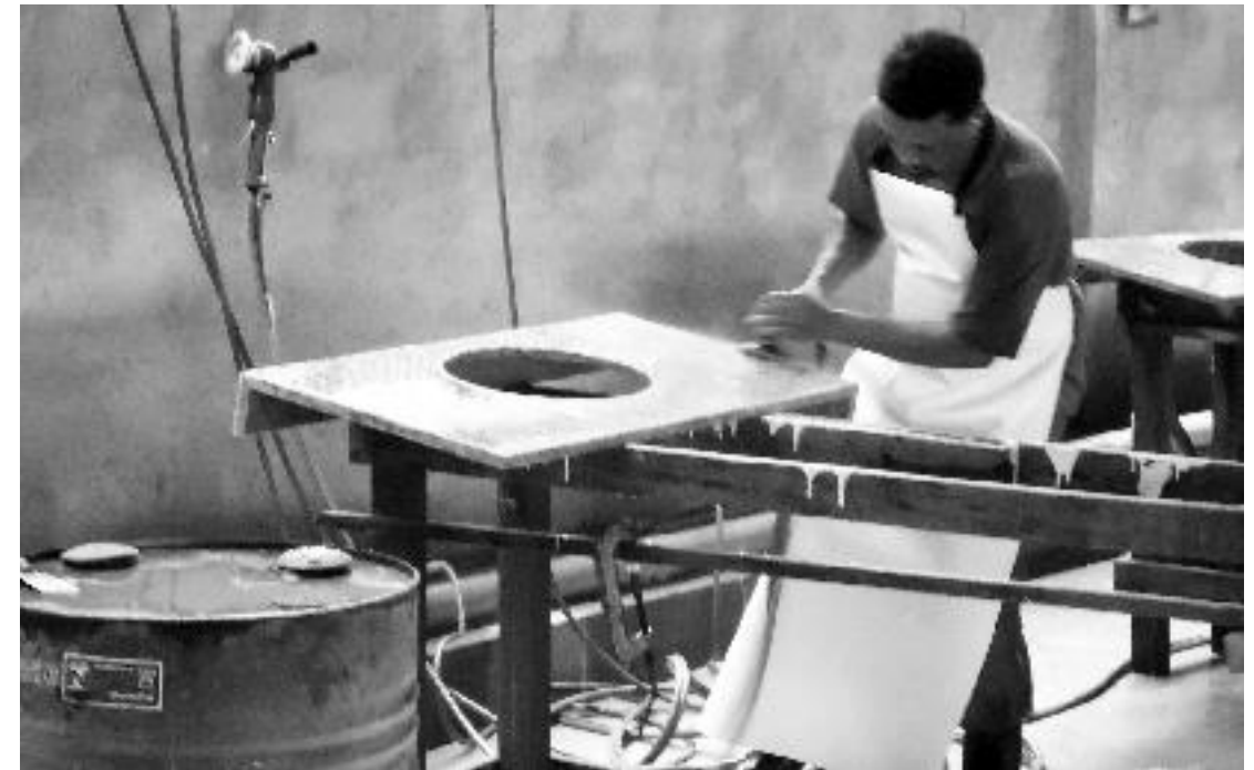
Figura 90 - Retoque no acabamento de borda com lixadeira manual. Foto: CETEM/MCTI, 2010.
