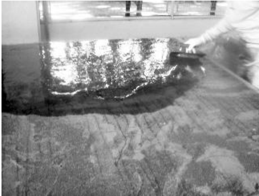
Figura 47 - Aplicação de resina no processo de telagem. Foto: CETEM/MCTI, 2011.
