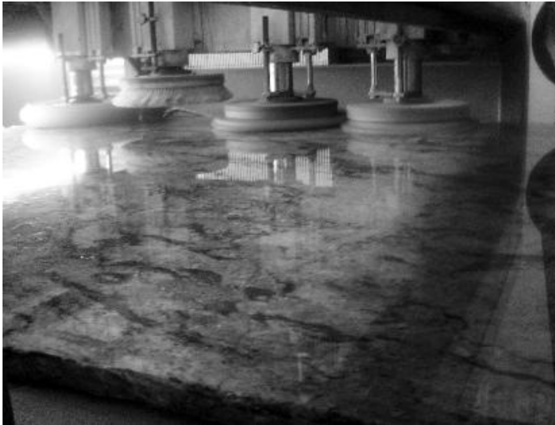
Figura 59 - Aplicação de intensificador de brilho em chapa de granito. Foto: CETEM/MCTI, 2009.
