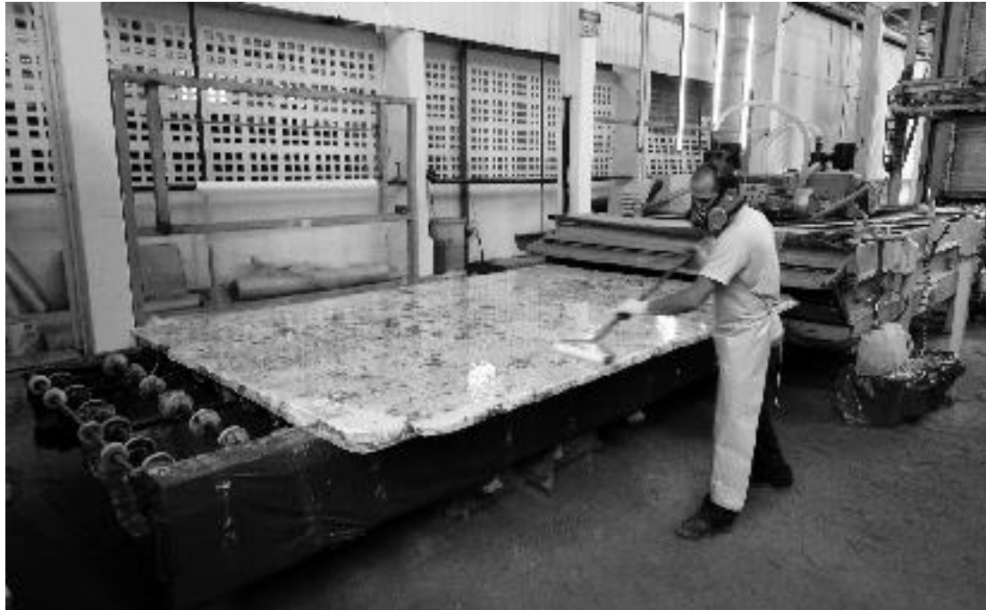
Figura 39 - Detalhe do procedimento de resinagem de chapas de rochas ornamentais. CETEM/MCTI, 2011.
