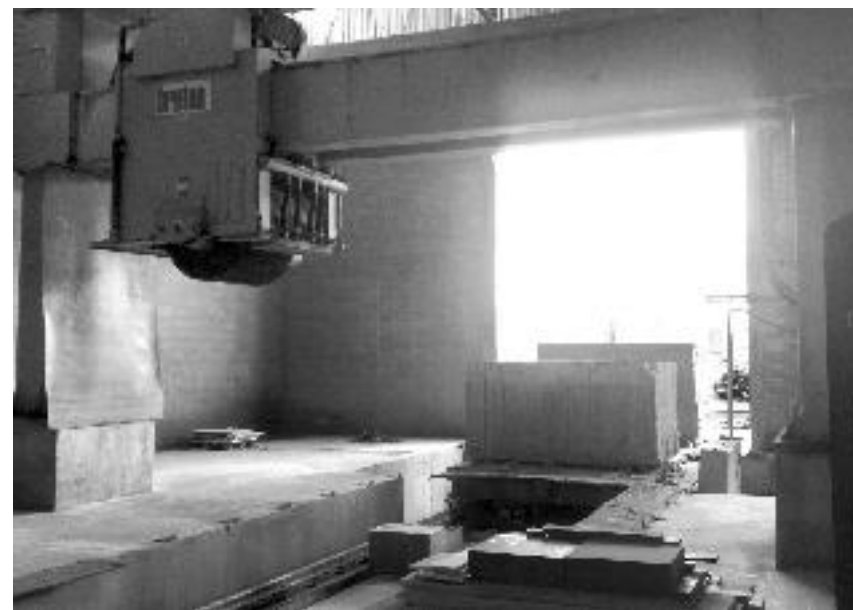
Figura 25 - Talha-blocos multidisco diamantados de 2 colunas. Foto: CETEM/MCTI, 2011.
