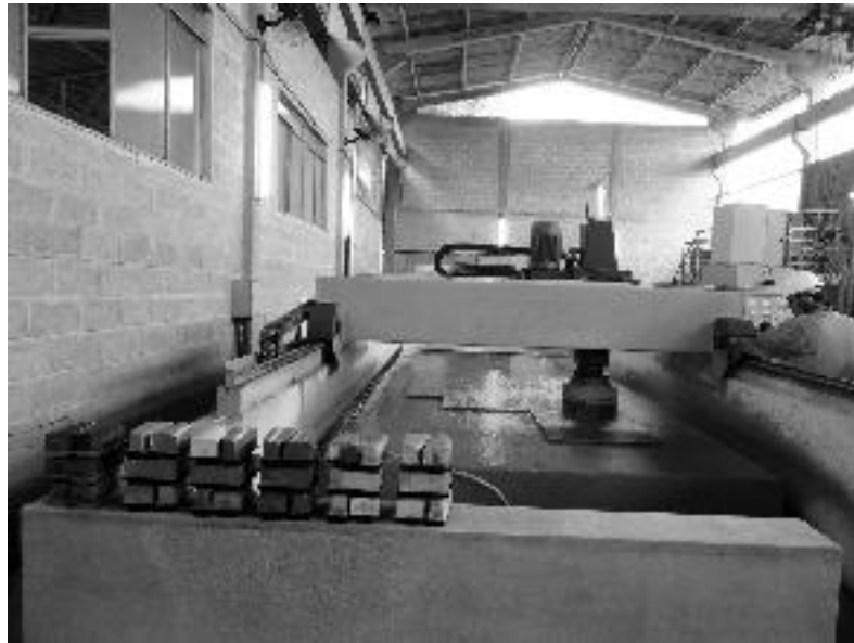
Figura 55 - Exemplo de politriz semiautomática de um cabeçote. Foto: CETEM/MCTI, 2011.
