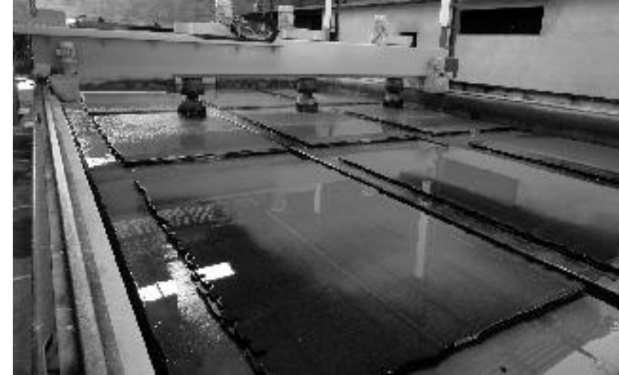
Figura 57 - Exemplo de politriz semiautomática de três cabeçotes. Foto: CETEM/MCTI, 2011.
