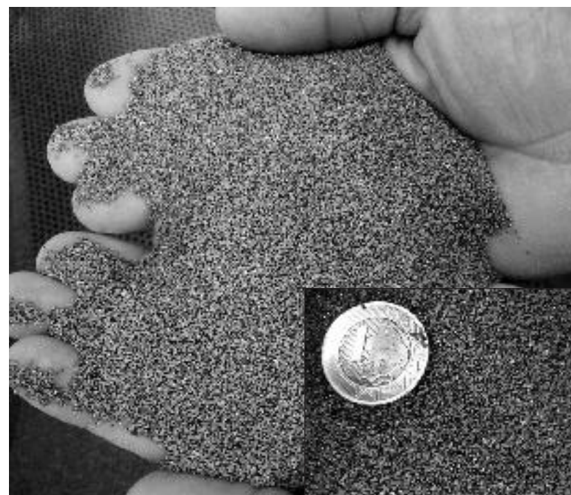
Figura 14 - Granalha utilizada na serragem de rochas ornamentais em teares multilâmina. CETEM/MCTI, 2012.
