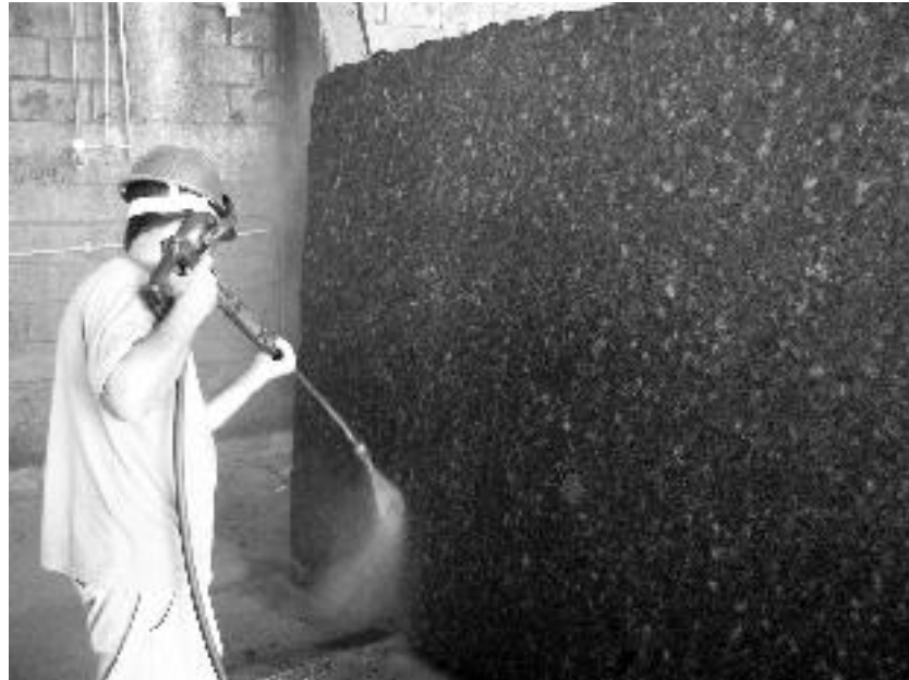
Figura 65 - Processo de jateamento de uma chapa de rocha ornamental. Foto: CETEM/MCTI, 2012.
