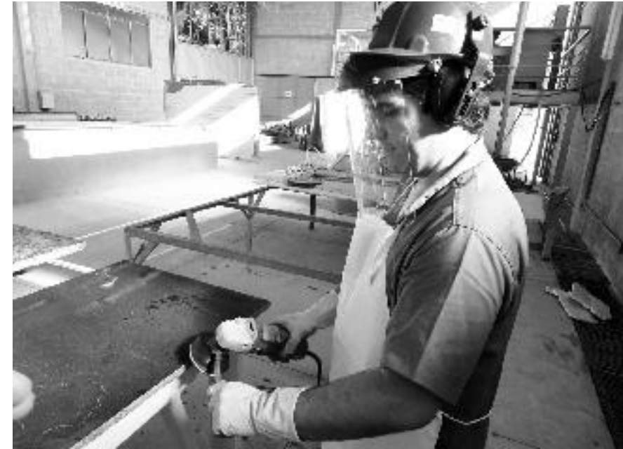
Figura 89 - Início de acabamento de borda com lixadeira manual. Foto: CETEM/MCTI, 2012.
