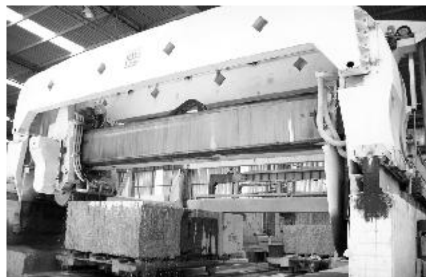
Figura 26 - Talha-blocos multidisco diamantados de quatro colunas. Foto: CETEM/MCTI, 2012.
