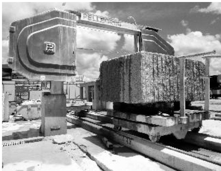
Figura 27 - Monofio diamantado para aparelhamento de blocos. Foto: CETEM/MCTI, 2011.
