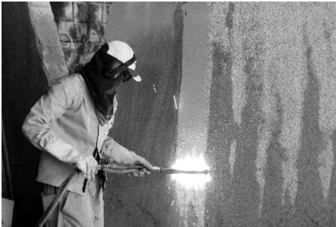
Figura 62 - Procedimento de flameamento de uma chapa de granito. Foto: CETEM/MCTI, 2012.
