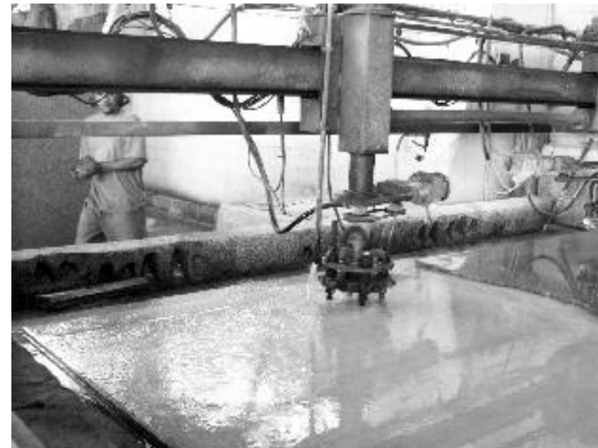
Figura 63 - Chapa de granito submetido ao processo de apicoamento. Foto: CETEM/MCTI, 2012.
