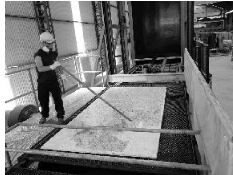
Figura 41 - Aplicação da resina numa chapa de granito. Foto: CETEM/MCTI, 2011.
