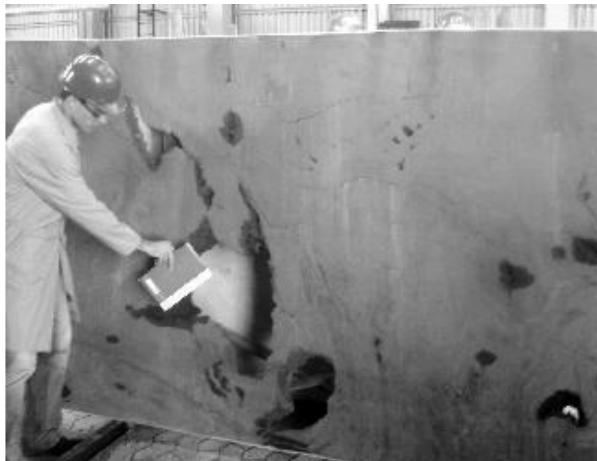
Figura 44 - Chapa de um jaspelito contendo vazios. Foto: CETEM/MCTI, 2009.
