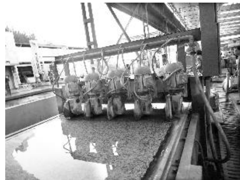
Figura 71 - Chapa a ser subdividida em fitas em cortadeira multidisco. Foto: CETEM/MCTI, 2012.
