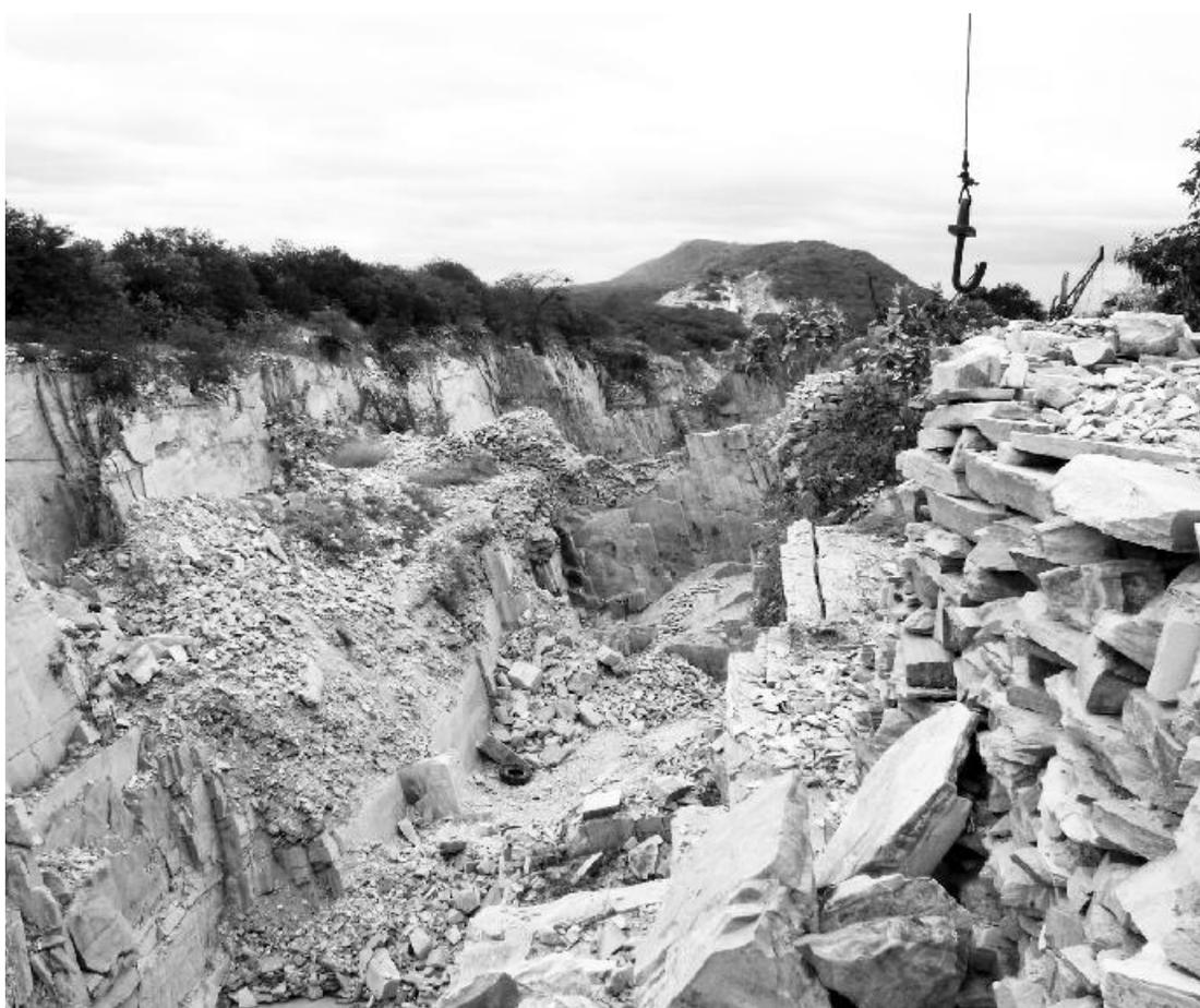
**Figura 2** - Riscos pelos taludes instáveis e resíduos mal dispostos. Foto: CETEM/MCTI, 2011.
