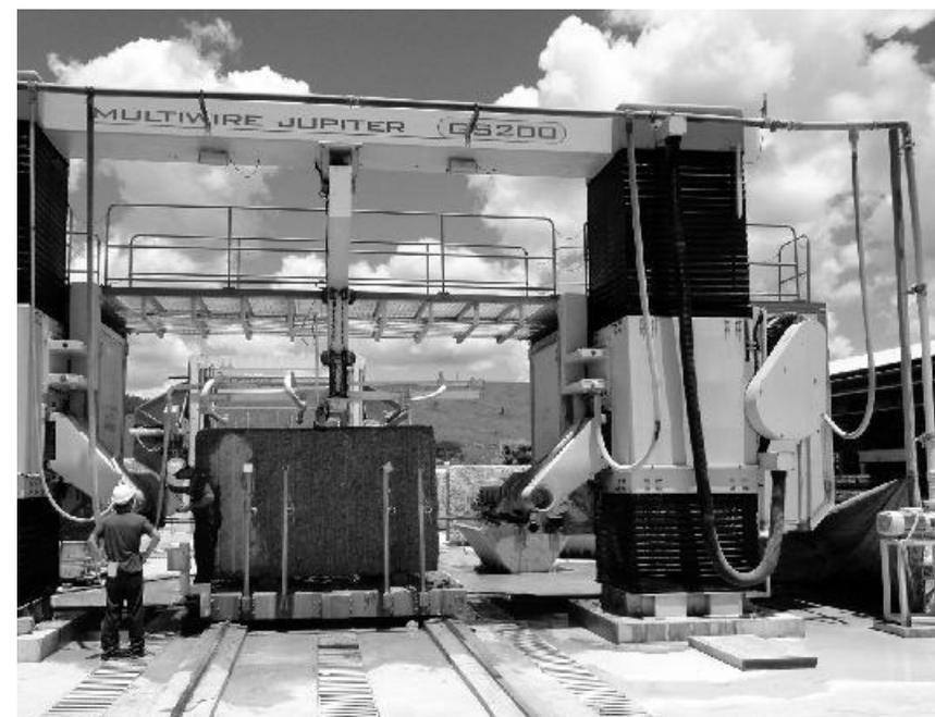
**Figura 9** - Operadores de tear multifio preparando a carga. Fonte: CETEM/MCTI, 2011.
