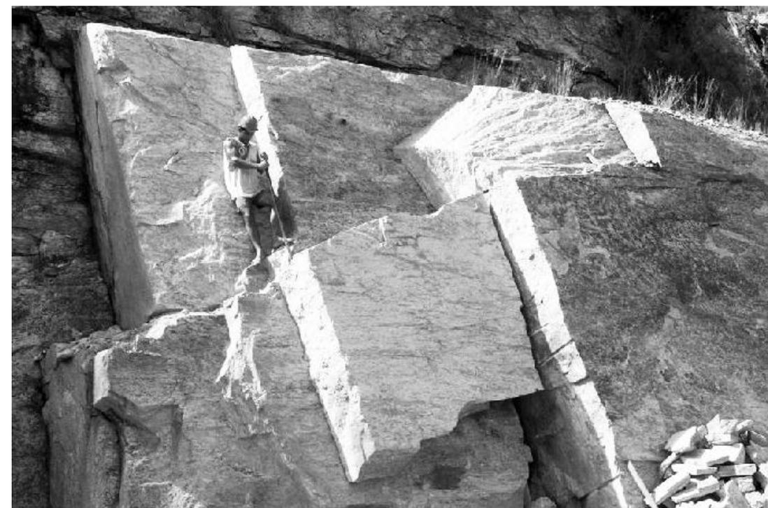
**Figura 1** - Exemplo de fatores de risco: não uso de EPIs, ferramentas inadequadas e, provavelmente, excesso de confiança e falta de treinamento. Foto: CETEM/MCTI, 2001.
