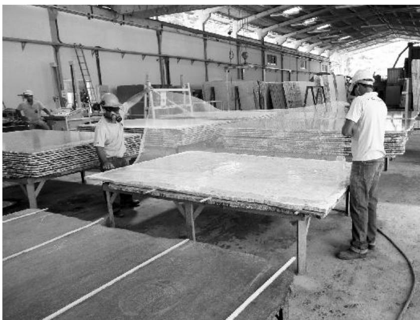
**Figura 12** - Operadores de resinagem colocando a tela. Foto: CETEM/MCTI, 2012.
