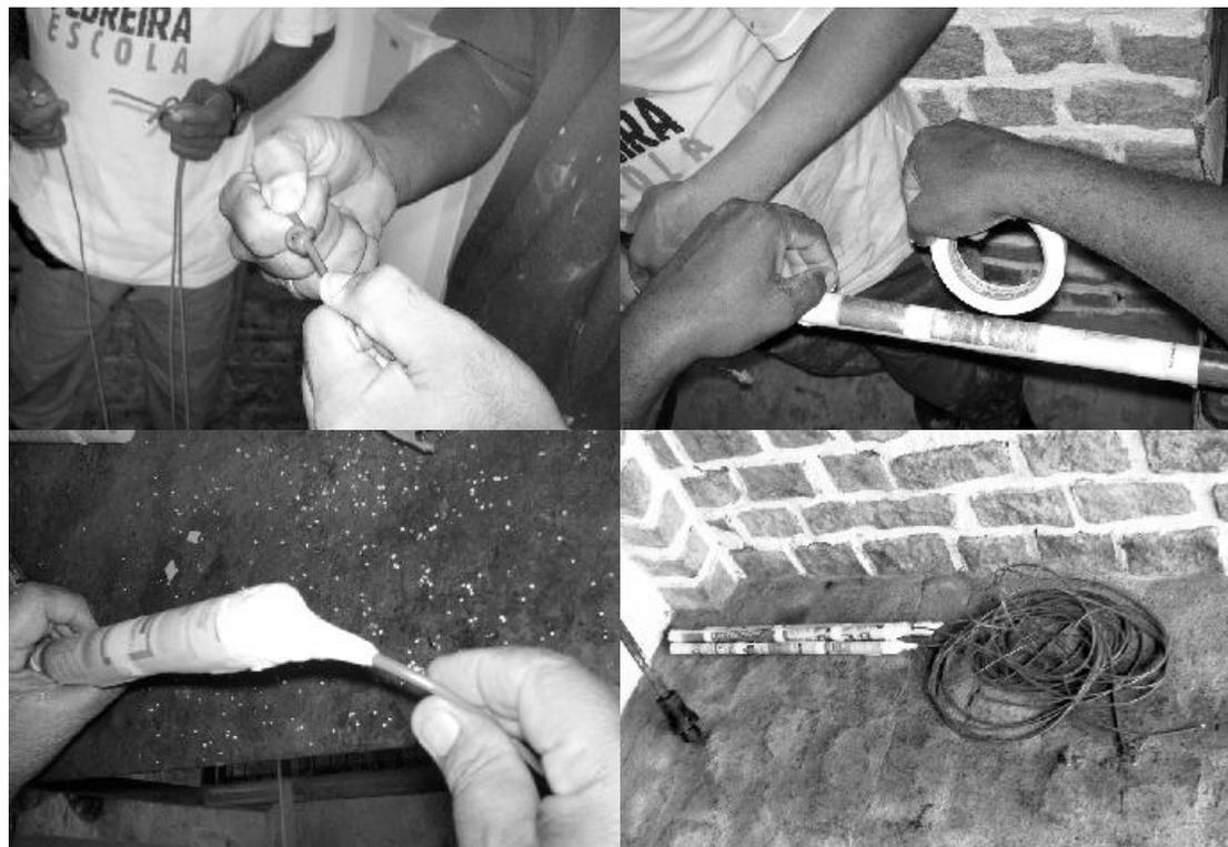
Figura 5 - Preparação de explosivo para corte do maciço. Fotos: CETEM/MCTI, 2007.
