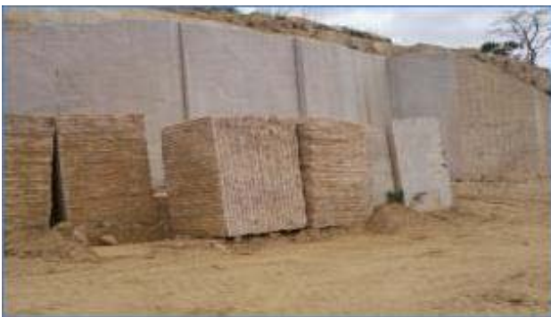
Figura 3 - Pedreira Saco da Serra: Frente de lavra mostrando o corte de blocos combinando massa expansiva e fio diamantado.
