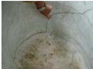
Figura 5 - Fissuras e fraturas encontradas nas banheiras
