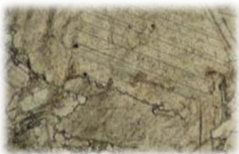
Figura 5 - Aspecto petrográfico de superfície de calcário cristalino (mármore) recentemente lustrado, de pedreira em clima semi-árido. Notar a limpidez geral dessas superfícies e a quase inexistência de preenchimentos (em óxidos de Fe) das clivagens dos minerais (calcita). LN/80x.
