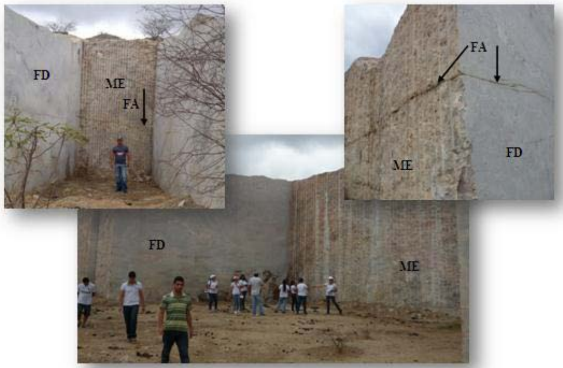
Figura 4 - Corte de rocha com massa expansiva (ME) e fio diamantado (FD) em frentes de lavra da Pedreira Tamanduá.
