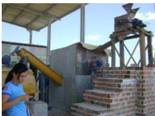
Figura 6 - Mostra o moinho de martelos (à direita e acima), peneira cilíndrica ("trommel") enclausurada, e transportador de rosca, alimentando os misturadores, à esquerda (tom amarelo).
