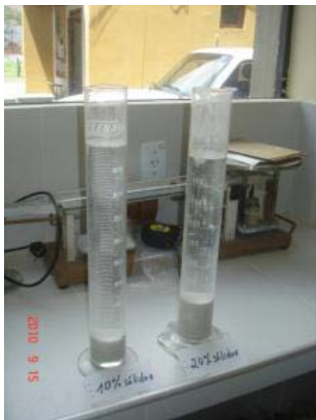
Figura 1 – Detalhe do ensaio de sedimentação realizado no laboratório com 10%, 20% e 30% de sólidos.
