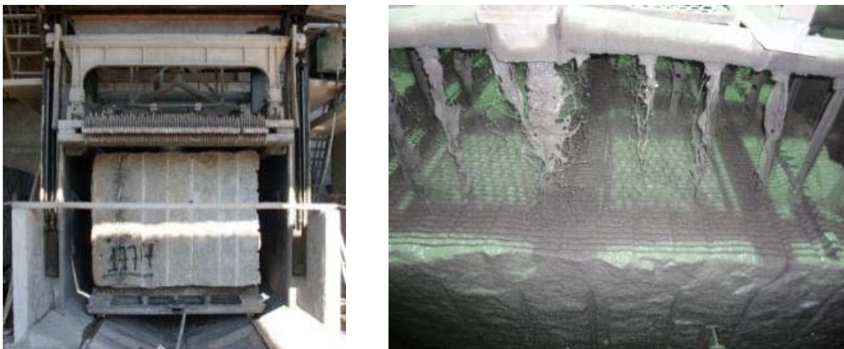
Figura 1 - Tear Multilâmina. Fotos: CETEM
