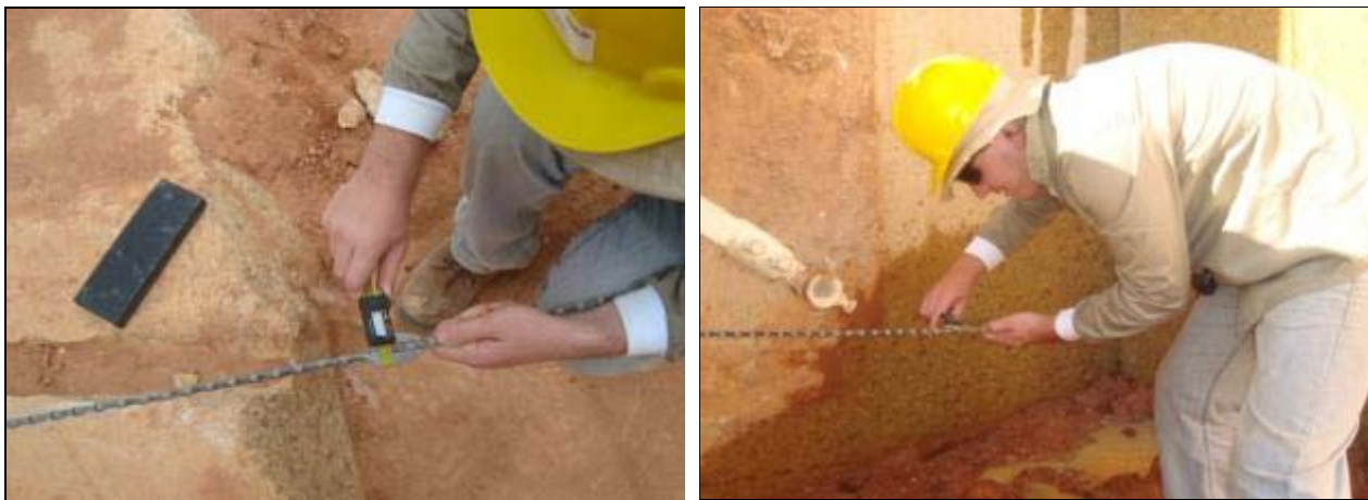
Figura 1 - Medições do desgaste do fio.
