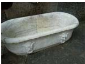
Figura 3 - Perda de massa rochosa devido à dissolução em meio ambiente quimicamente agressivo.
