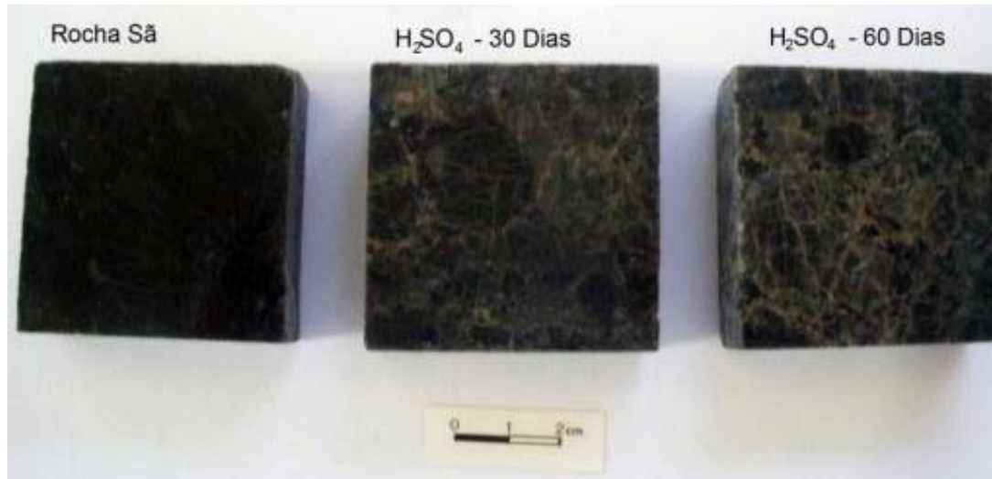
Figura 9 - Diferentes aspectos do Marrom Imperial, fácies exportação, sob lixiviação de H 2 SO 4 , desde rocha sã a condições de lixiviação por 30 e 60 dias.
