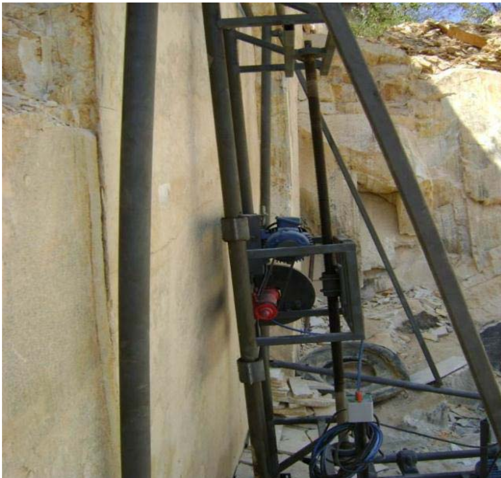
Figura 6 - Máquina de corte desenvolvida, com sistema de fixação. Fonte: CETEM / MCTI
