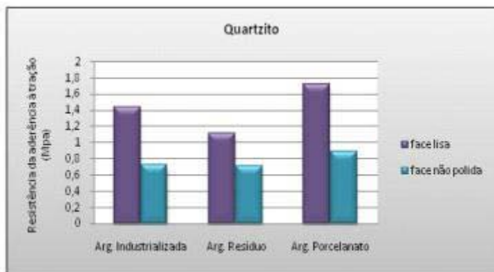
Figura 11 - Gráfico da resistência da aderência à tração do quartzito assentados na face lisa e não polida.
