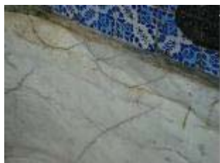
Figura 5 - Fissuras e fraturas encontradas nas banheiras
