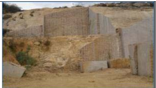
Figura 3 - Pedreira Saco da Serra: Frente de lavra mostrando o corte de blocos combinando massa expansiva e fio diamantado.
