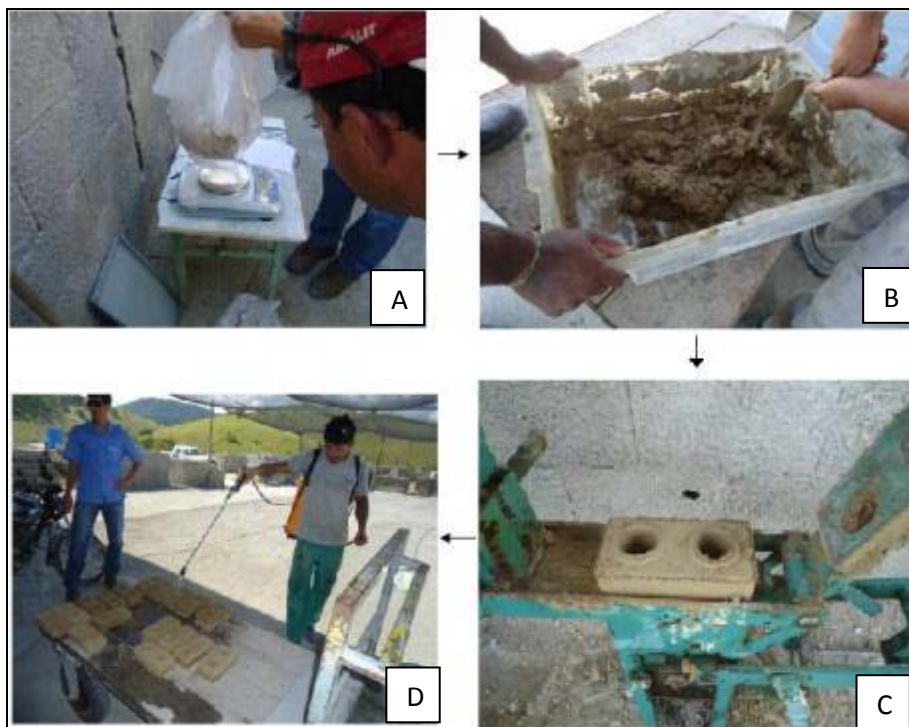
Figura 2 – Procedimento adotado para a preparação dos tijolos: (A) pesagem das porções constituintes; (B) homogeneização; (C) prensagem; (D) cura dos corpos de prova.
