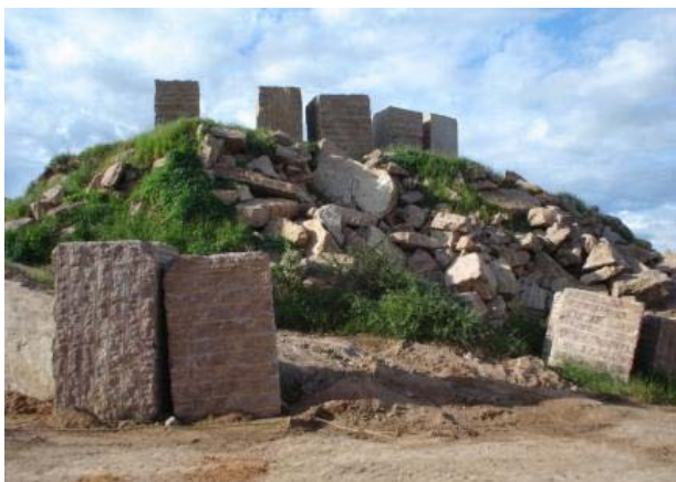
Figura 01 – Fotografia mostrando detalhes de material estéril e resíduos gerados na operação da lavra e abandonados nas encostas e no acesso à pedreira de Picui - PB.
