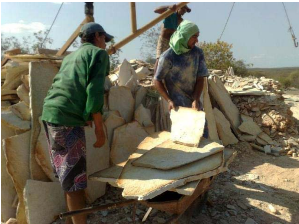
Figura 4 - Lajes irregulares extraídas das pedreiras. Fonte: CETEM/MCTI
