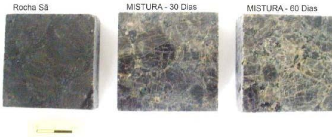
Figura 10 - Diferentes aspectos do Marrom Imperial, fácies exportação, sob lixiviação de mistura HNO 3 + H 2 SO 4 , desde rocha sã a condições de lixiviação por 30 e 60 dias
