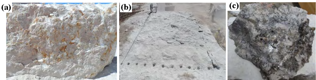
Figura 1 – Amostra do granito pegmatóide: (a) natural; (b) sendo cortada e (c) após desbaste
