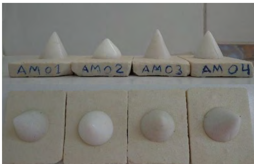
Figura 4: Foto lateral e de topo dos cones de fusão após ensaio.
