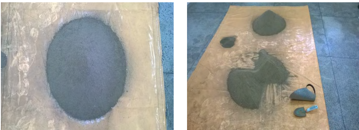
Figura 1- Procedimento de homogeneização e quarteamento das amostras.
