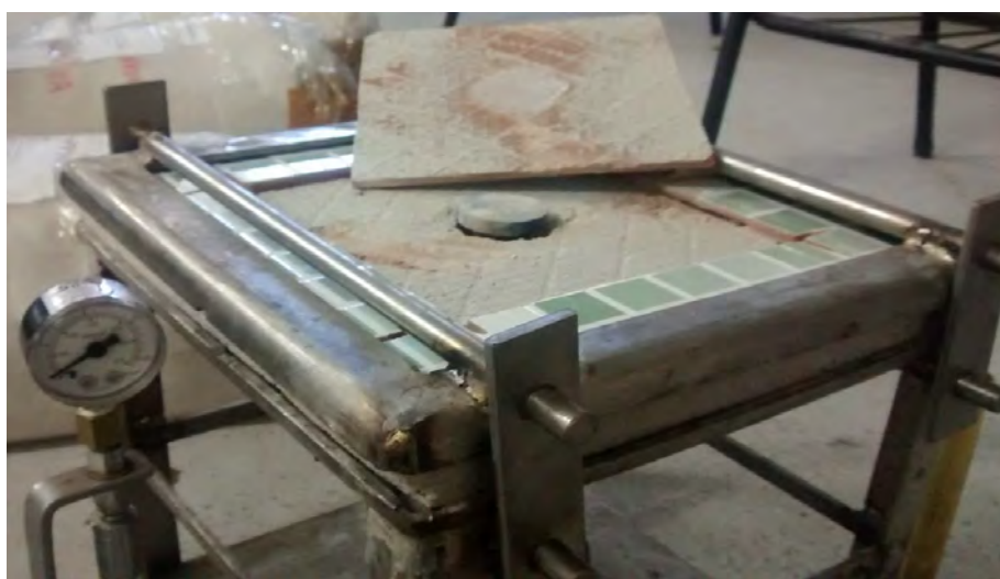
Figura 4 – Equipamento usado para o ensaio de resistência ao arranque por tração simples.
