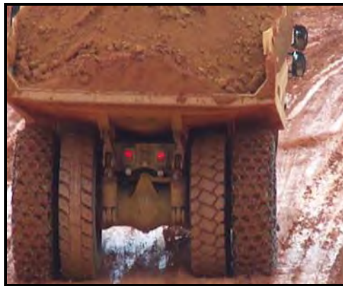
Figura 4 – Pneu com blindagem – maior aderência com área de contato
