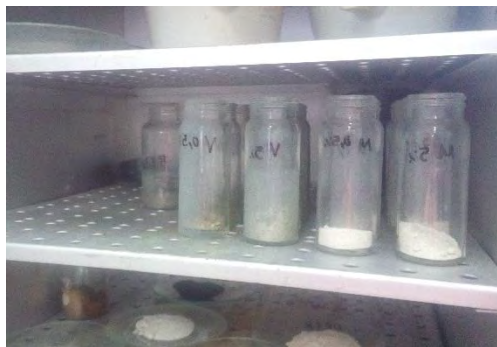
Figura 3 – Amostras submetidas a temperatura de 105°C em estufa.
