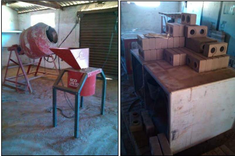
Figuras 8 e 9 – Protótipo de unidade de processamento de artefatos para a construção civil e Tijolos confeccionados a partir dos rejeitos da extração de opalas. (Elaboração dos autores).
