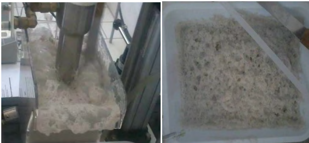
Figura 2 – Espumas geradas durante a flotação do granito-pegmatóide
