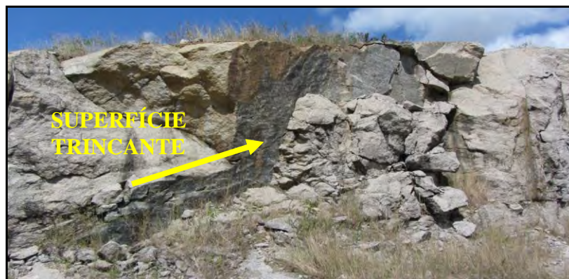
Figura 5: Ilustração das superfícies trincante de uma fratura na frente de lavra da bancada D, Mineração Aurora.
