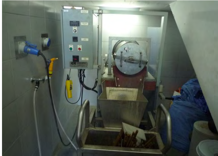
Figura 1 – Unidade de moagem CPT (Usina Piloto do CETEM)
