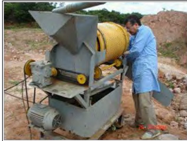
Figura 2 – Trommel Gold Saver utilizado na primeira etapa do projeto (Elaboração dos autores).
