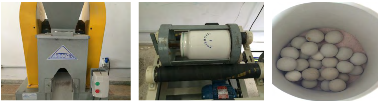
Figura 1- (a) Britador de mandíbulas da marca Astecma; (b) moinho de bolas; (c) corpos moedores com diferentes diâmetros (Acervo pessoal, 2015).
