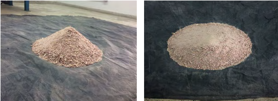
Figura 2 – Formação de pilhas cônicas para homogeneização e preparação de amostras representativas (Acervo pessoal, 2015).
