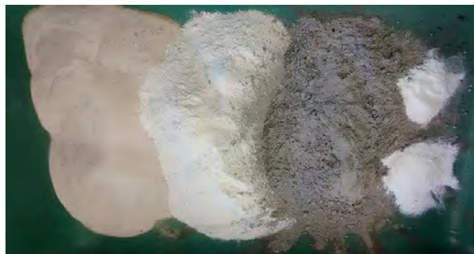
Figura 2 - Componentes utilizados para composição da argamassa. Na sequência: areia, resíduo de caulim, cimento Portland e aditivos: éter de celulose e PVA.
