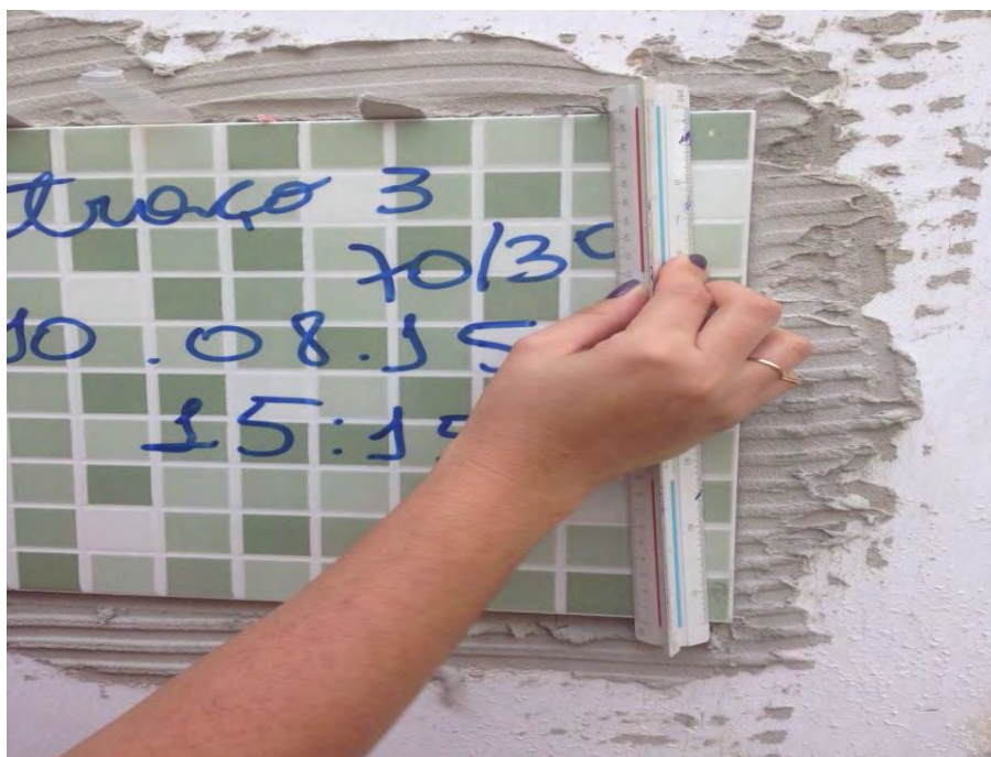
Figura 3 – Detalhe do ensaio de deslizamento no qual se mede o deslocamento da cerâmica após 24 h.
