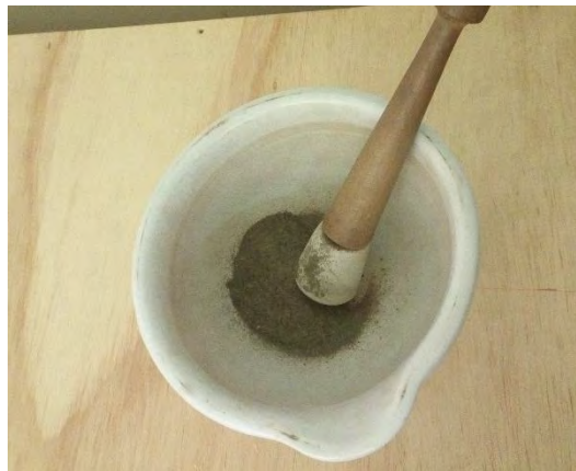
Figura 1 – Processo de pulverização da vermiculita com auxílio de um almofariz.
