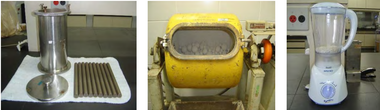
Figura 2 – Moinhos utilizados na moagem secundária: (a) de barras, (b) de bolas e (c) de facas adaptado
