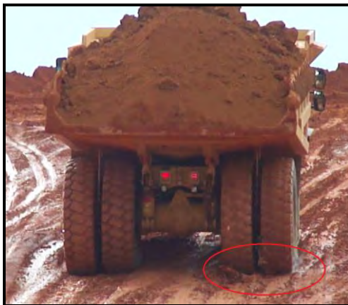
Figura 3 – Ausência de aderência entre o pneu e o solo
