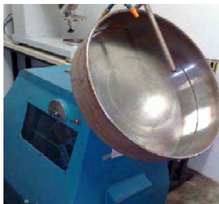
Figura 1. Disco pelletizador do laboratório de aglomeração do Instituto Federal do E.S - Ifes
