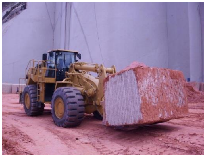
Figura 5 – Pá carregadeira adaptada pra transporte de blocos.
