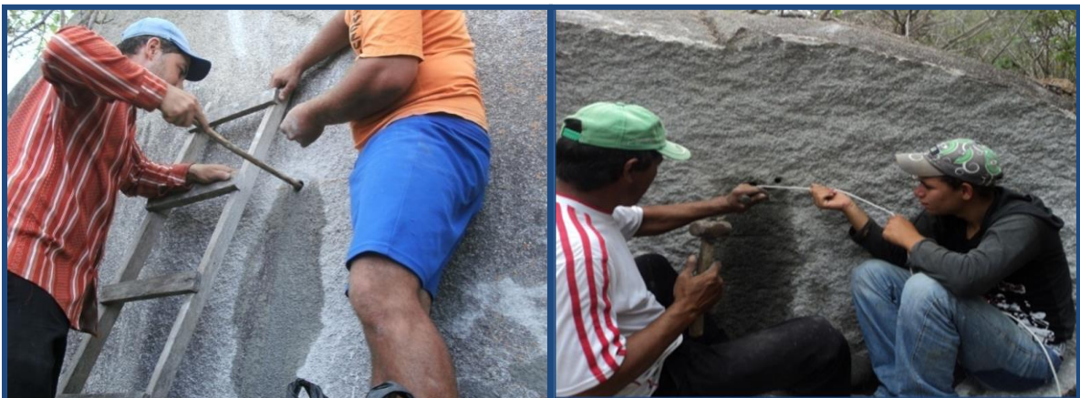
Fig. 3. Carregamento do furo com explosivo, de forma manual.
