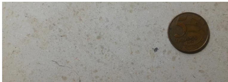
Figura 4 – Análise macroscópica do limestone Crema Paraná (Elaboração dos autores)
