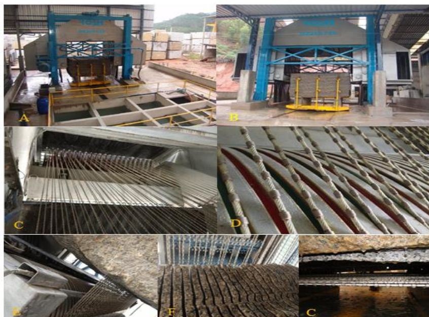
Figura 02: Estrutura do Tear multifio (A) e (B) Visão panorâmica do tear multifio. (C) e (D) Espaçamento entre os fios diamantados (E) e (F) Serragem do bloco. (G) Término da serragem
