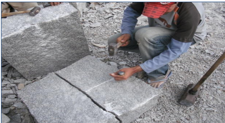
Fig. 7. Processo de divisão do lapão em duas moretas.
