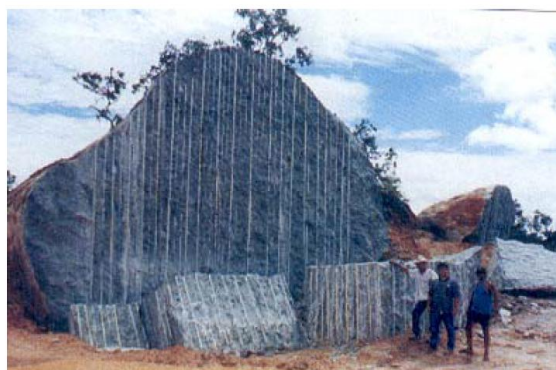
Figura 2 - Corte em matacão efetuado com argamassa expansiva - Piranhas/GO. Fonte: Matta, 2003.
