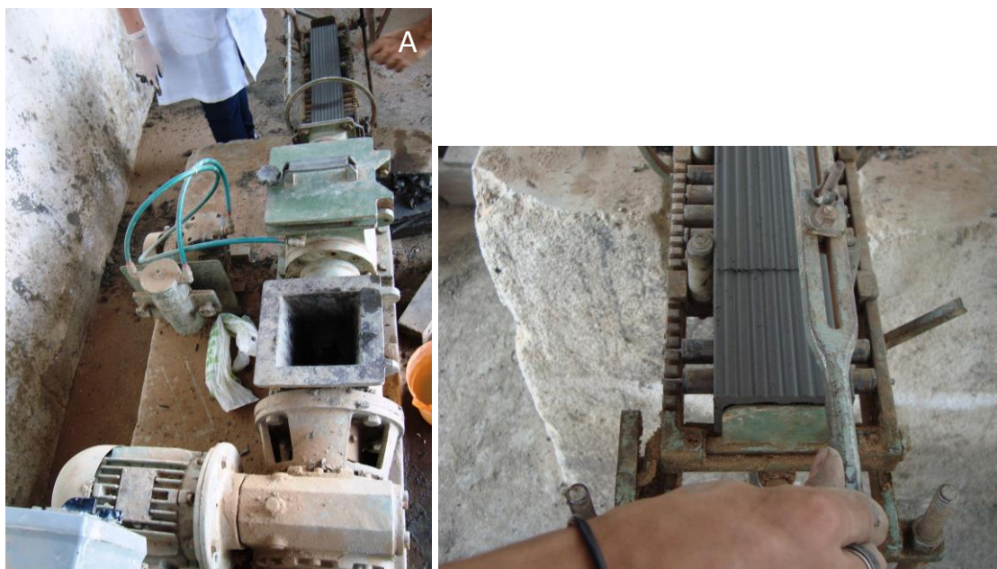
Figura 2 – Extrusora utilizada no processo (A) e os tijolos sendo cortados(B) (Fonte dos autores)
