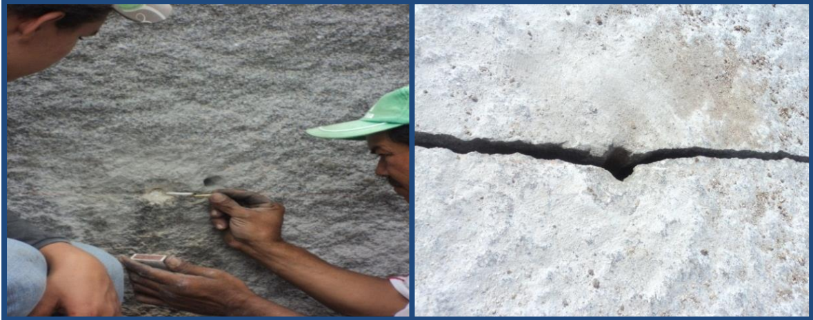
Fig. 4. Acendimento do estopim e divisão do bloco após explosão.
