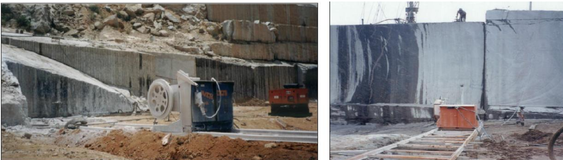
Figura 5 - Fio diamantado em uso. Fonte: Lima, 2010.
