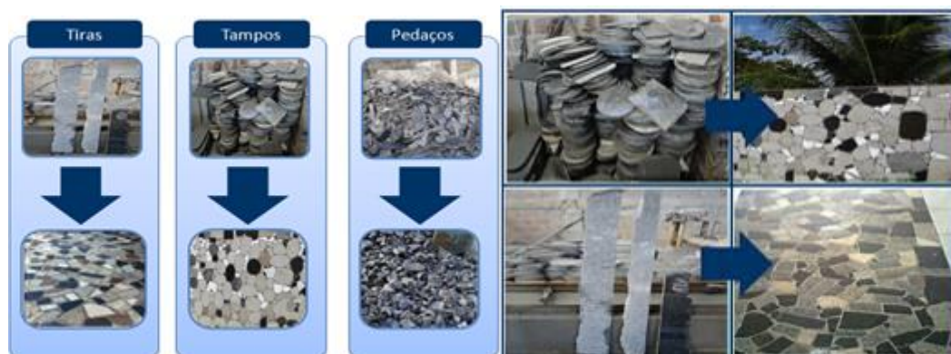
Figuras 2 - Reutilização dos rejeitos gerados na linha de produção
