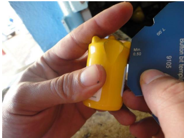
Figura 8 - Bit descartado por não apresentar boas condições de limpeza do furo.
