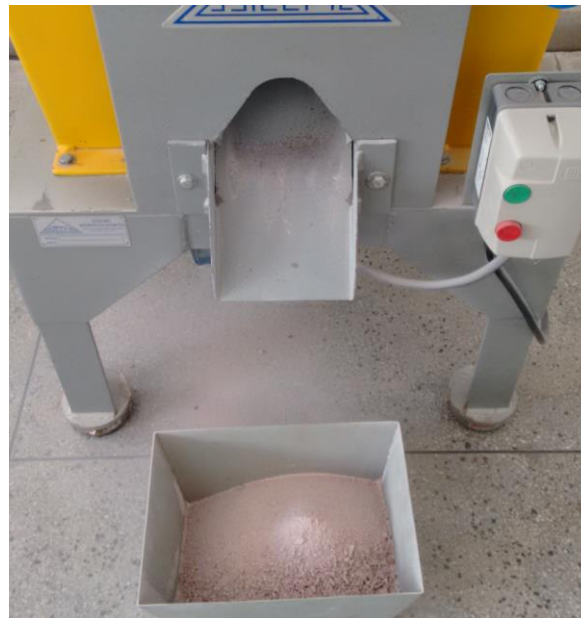
Figura 2 – Britagem das amostras em britador de mandíbulas Astecma (acervo pessoal)
