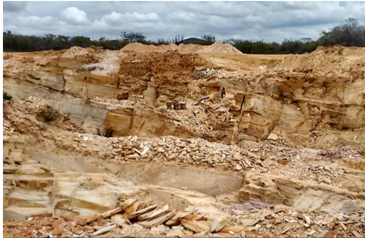
Figura 1 – Resíduos provenientes da extração do quartzito na região do Seridó - PB (acervo pessoal)
