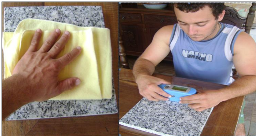
Figura 1 - Procedimento de limpeza e medição do brilho nos ladrilhos utilizados na pesquisa.
