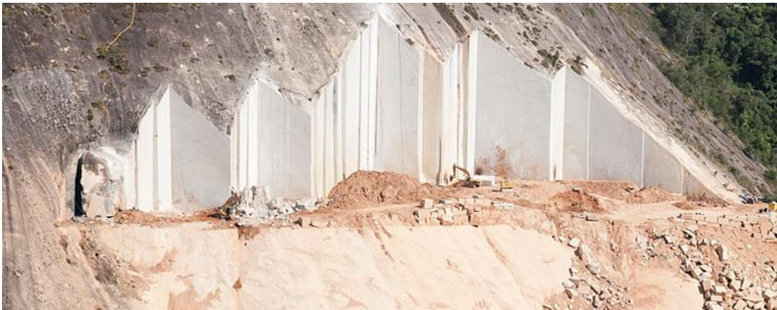
Figura 1 – Bancada ultra-alta encontrada no Noroeste do Espírito Santo (MINERAÇÃO GUIDONI, 2016)
