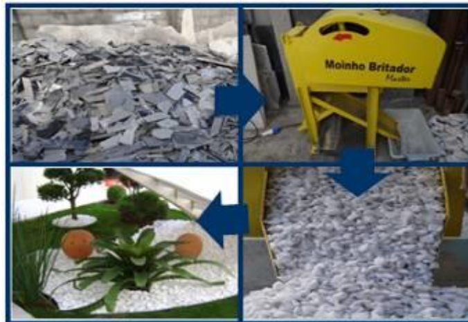
Figura 6 - Processo de produção de material britado de sobras de rocha ornamental
