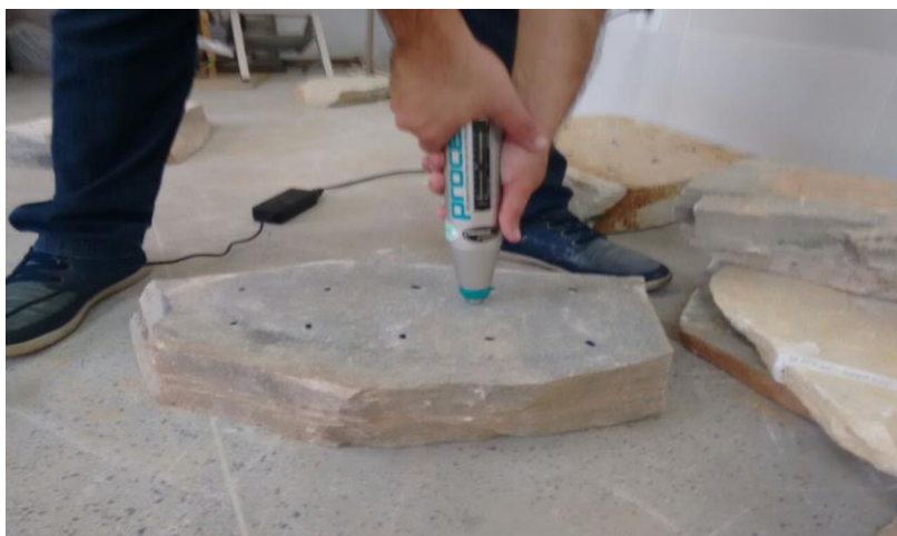
Figura 4- Manuseio do martelo nos testes em quartzitos.
