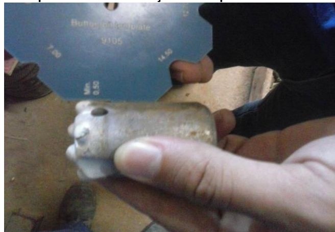
Figura 8 - Bit descartado por não apresentar boas condições de limpeza do furo.
