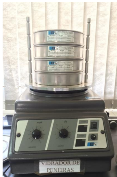
Figura 4 – Vibrador de peneiras eletromagnético com: 3 peneiras (#14, #28, #48) mais fundo cego. (Acervo pessoal)
