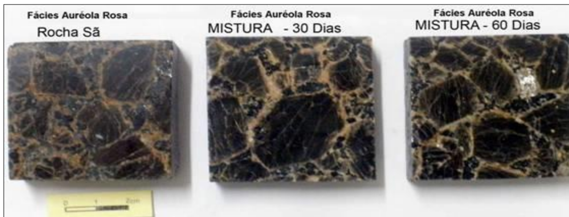
Figura 4 - Diferentes aspectos do Imperial Brown fácies auréola rosa, sob lixiviação da mistura \text{H}_2\text{SO}_4/\text{HNO}_3 , desde rocha sã, a condições de imersão por 30 e 60 dias.
