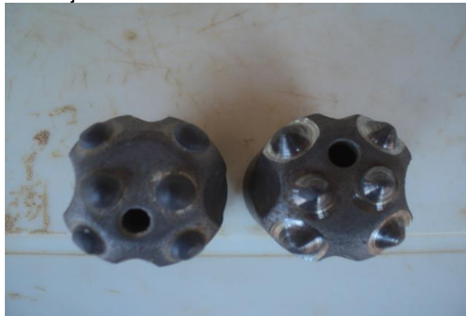
Figura 4 - Bits antes e depois da afiação.
