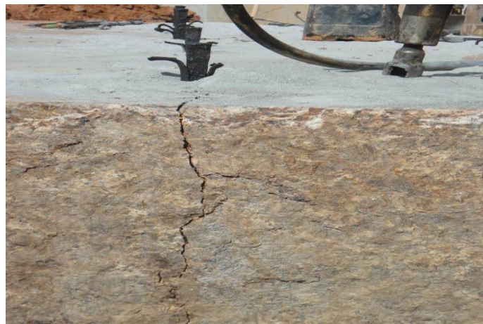
Figura 6 - Operação de bate cunha criando um plano de fraqueza na rocha para seu fraturamento em uma direção
