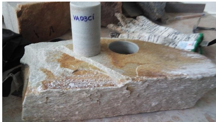
Figura 5 – Plugue da amostra após o processo de serragem, passagem pela plugadeira de bancada e a retificadora.
