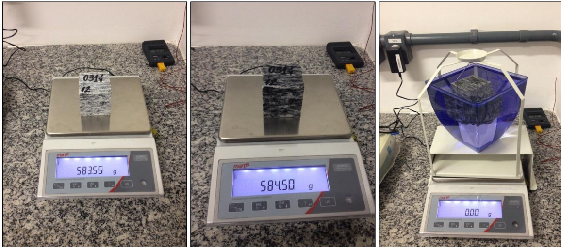
Figura 2 – Determinação de massa seca, saturada e submersa ABNT NBR 15845-2:2015 (Elaboração dos autores)
