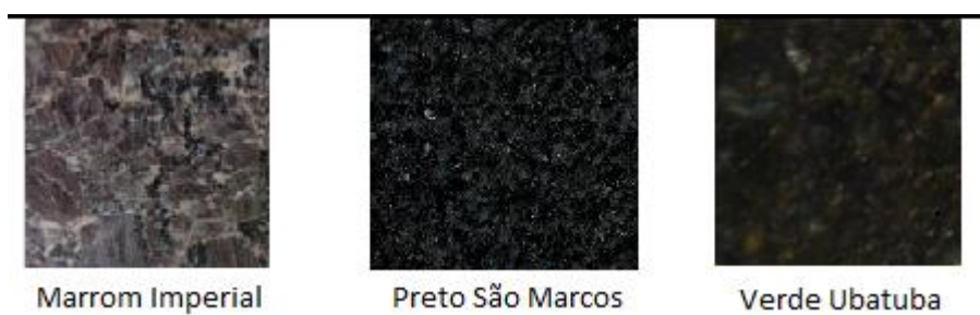
Figura 2. Aspectos visuais dos granitos Marrom Imperial, Preto São Marcos e Verde Ubatuba.
