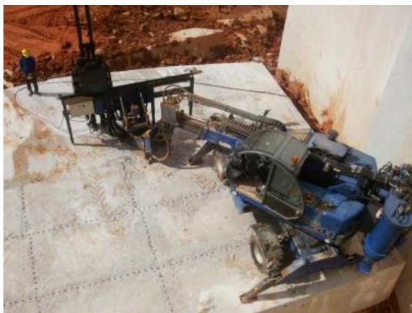
Figura 3 – Prancha sendo esquadrejada em blocos (Fonte: Maior, 2013).
