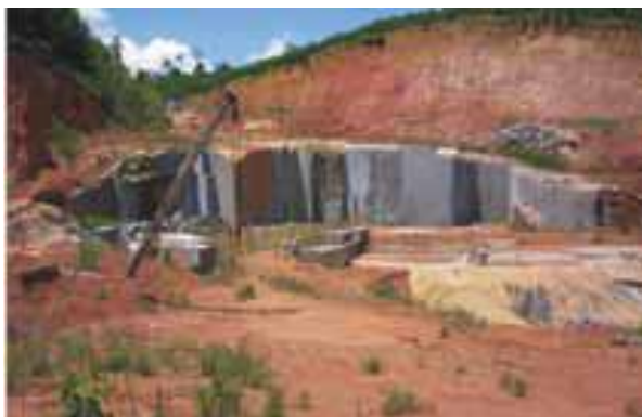
Foto 1 - Aspecto da mina do “Granito Blue Brasil ” lavrado a partir de paragneisses do Complexo Nova Venécia (município de Rio Bananal. Fonte: Baltazar et al , 2010).
