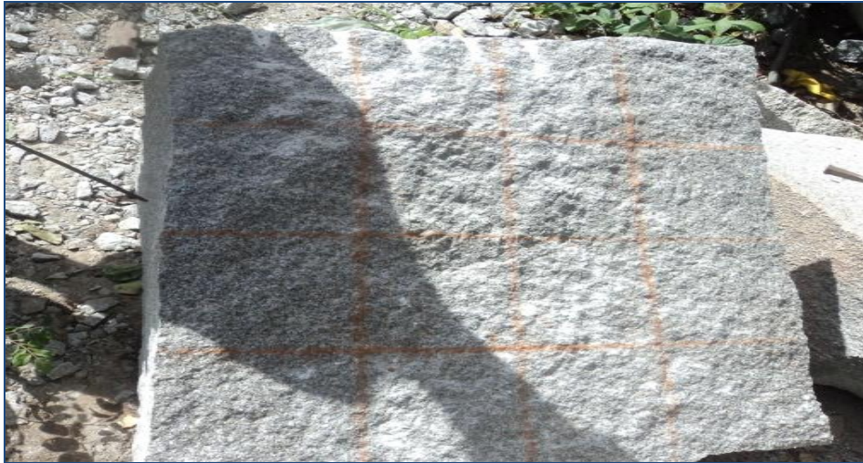
Fig. 6. Processo de divisão do tório para esquadrejamento.
