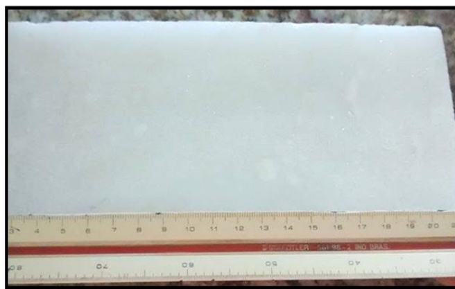
Figura 1 – Chapa polida do mármore de São Rafael. (Fonte: Própria).
