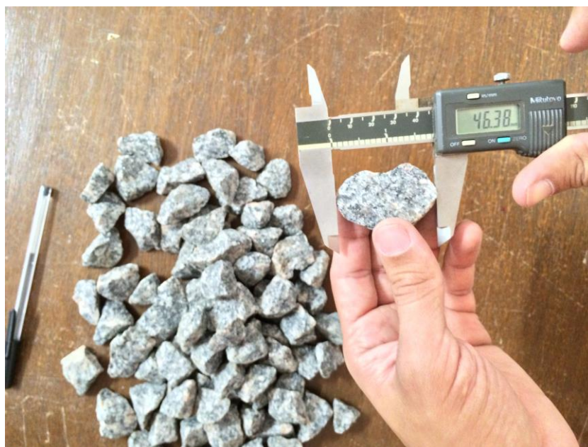
Figura 1 – Medição das britas com uso do paquímetro
