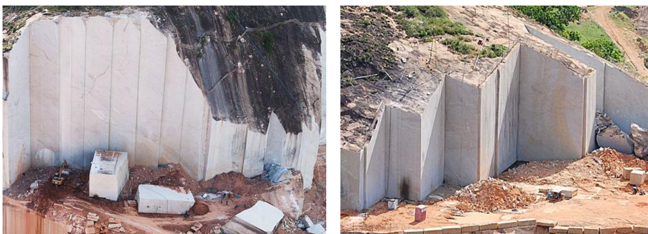
Figura 1 – Bancadas ultra-altas encontradas no Noroeste do Espírito Santo (MINERAÇÃO GUIDONI, 2016).
