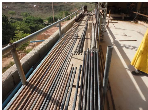
Figura 2 – Hastes de extensão utilizadas na perfuração dos gnaisses
