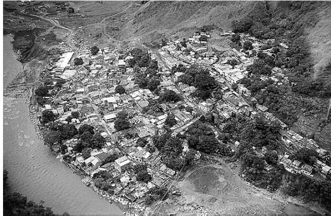
FOTO 4. Vista aérea de Chima diez días después del deslizamiento. Al fondo (izquierda superior) se aprecia cómo ha desaparecido el segundo brazo del río Tipuani (que fluye de abajo arriba); este canal arrancaba de la zona más oscura en donde unas máquinas están intentando restablecerlo. El deslizamiento fue reconducido hacia la parte superior izquierda de la foto por un talud lateral de la explotación a cielo abierto de Chima Limitada; de no haber existido este talud, la parte del pueblo enterrada habría sido mucho mayor abarcando posiblemente el tercio superior o más de la población mostrada en la foto
