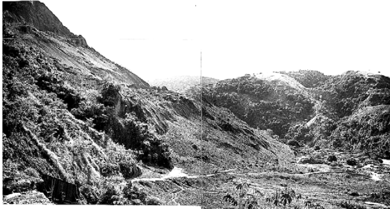
FOTO 7. Perspectiva del deslizamiento con Chima en la parte derecha. Se aprecia la parte superior del terreno deslizado (hacia la mitad del talud). El material descansa en gran parte sostenido por la plataforma de trabajo del cielo abierto de la cooperativa Chima
