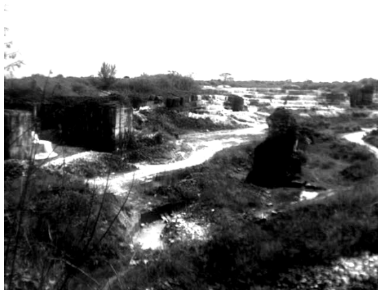
Foto 1 - Zona de extraccion antigua en el sector j-4 (flanco sur). obsérvese en primer plano la acumulacion de agua en el piso de la cantera y al fondo como quedo el frente de extraccion
