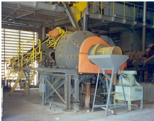
Figura 4.43 - Moinho autógeno – Unidade Piloto do CETEM.
