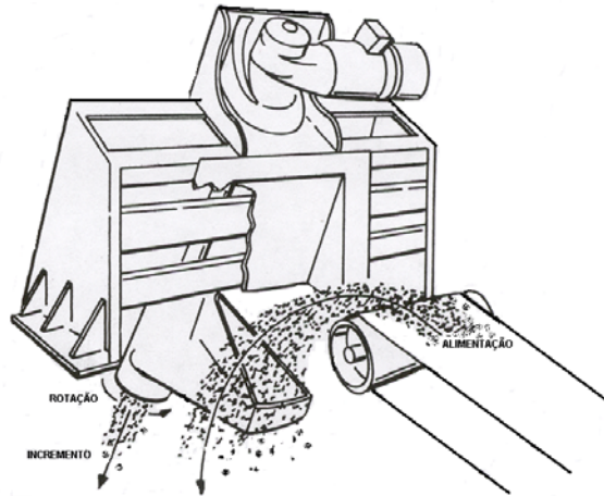
Figura 2.2 - Amostrador com trajetória circular.
