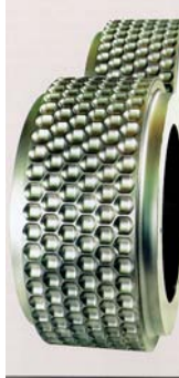
Figura 15.6- Rolos sólidos, que permitem a substituição das tiras que dão forma aos briquetes (16) .
