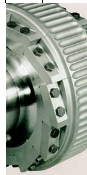
Figura 15.7- Rolos segmentados para aplicações de materiais altamente abrasivos (16) .
