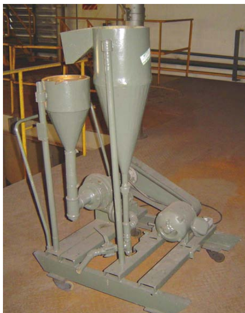
Foto 1 – Equipamento para ensaios de Afunda-Flutua.
