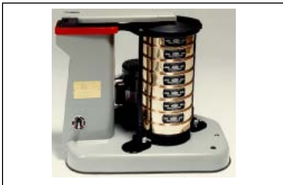
Figura 15.4 - Peneirador vibratório, do tipo ro-tap , utilizado nos ensaios de resistência à abrasão.
