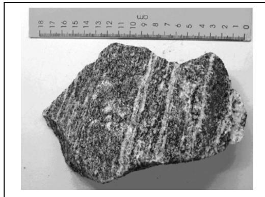
Figura 4 – Detalhe de uma rocha gnáissica com bandamento composicional. Pedreira para extração de brita, Valença, Rio de Janeiro.
