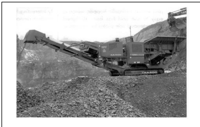
Figura 15 – Peneiras móveis utilizadas diretamente na frente de lavra.
