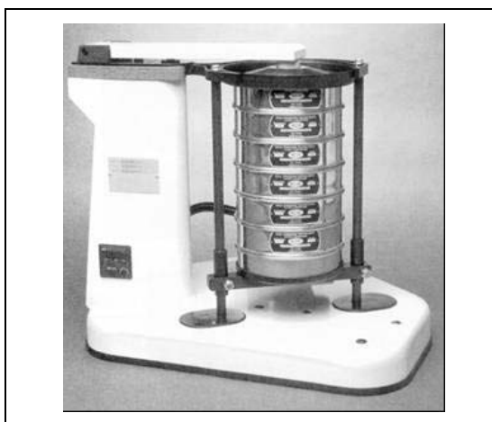
Foto 1 – Peneirador tipo Ro-TAP para análise granulométrica a seco.
