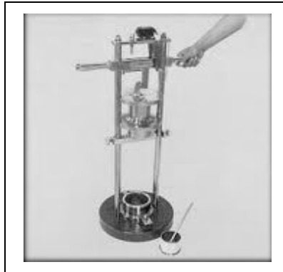
Foto 3 – Equipamento para teste de impacto de agregado.
