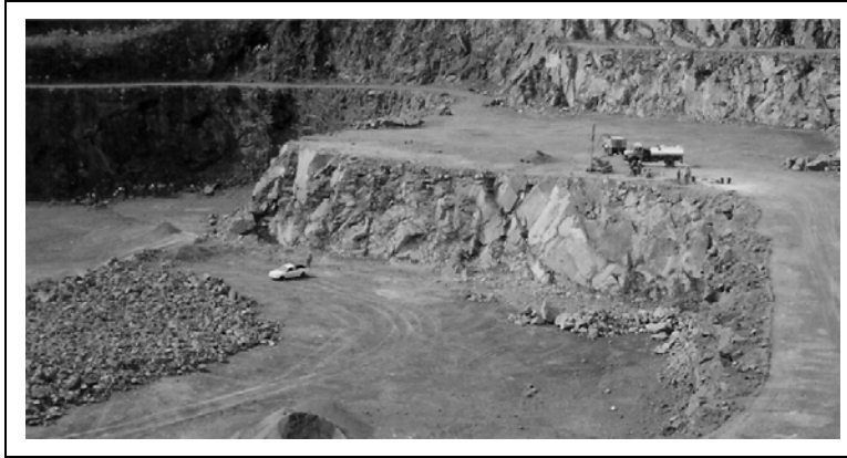
Figura 8 – Desmonte em bancadas em pedreira de basalto.
