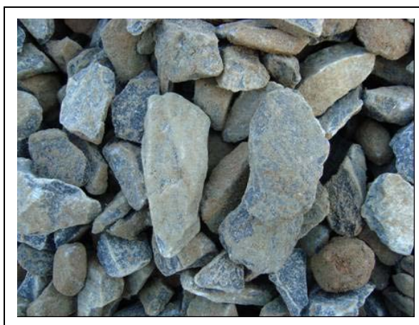
Figura 1B – Agregado de Calcário da Formação Bambuí, empresa Brita Verde, São José da Lapa-MG.
