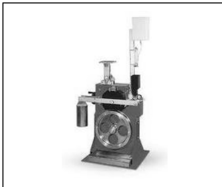
Foto 2 – Máquina de polimento acelerado.
