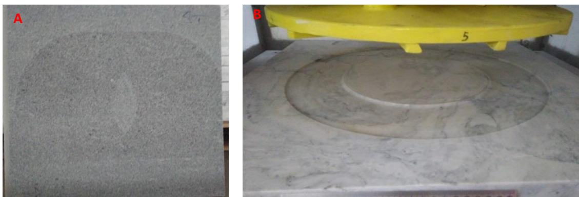
Figura 8. (A) Chapa de rocha silicática aplicada no procedimento de desgaste dos rebolos convencionais (chapa de 60 cm de largura). (B) Chapa de mármore aplicada no procedimento de desgaste dos rebolos resinoides (chapa de 60 cm de largura).
