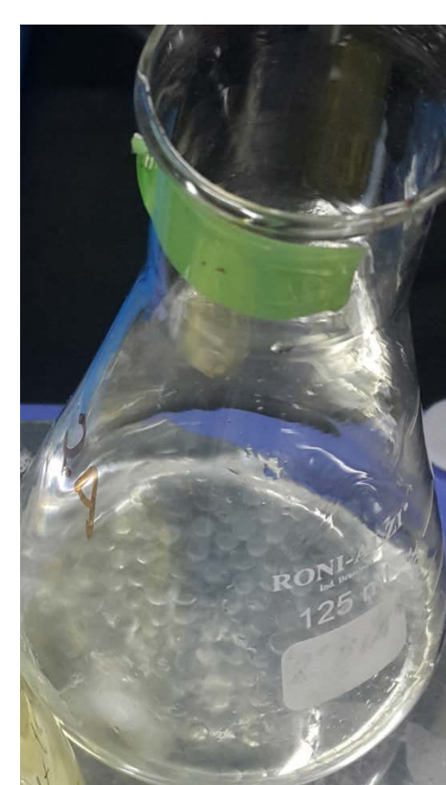
6 - Biossorventes formados por bactérias + alginato de sódio immobilizadas em solução de CaCl 2 1M.
