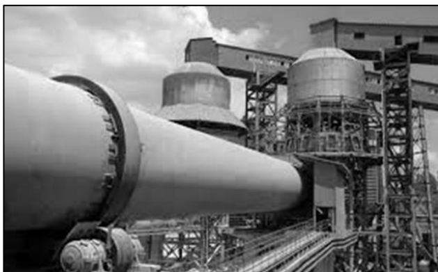
Figura 3. Forno rotativo de calcinação para produção de cal.
