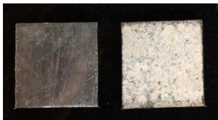
Figura 7. Sucata com a camada de zinco sem sofrer oxidação e sucata com a camada de zinco já oxidada.
