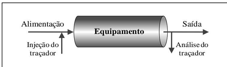
Figura 2. Esquema do aparato de estímulo/resposta utilizado para obtenção da DTR.
