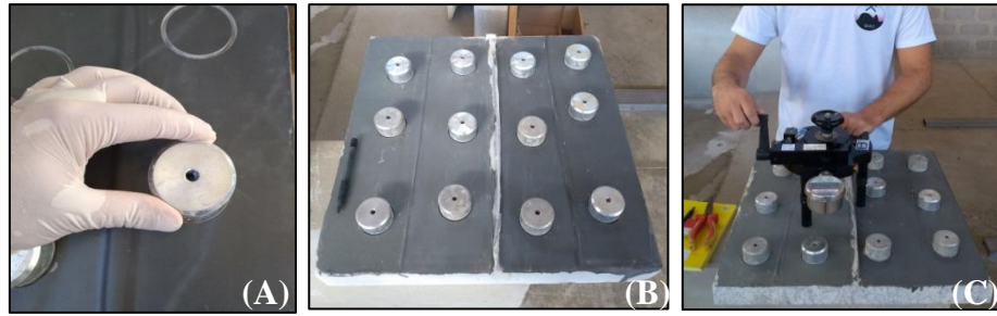
Figura 2: Colagem de pastilha no furo (A). Amostra resinada e com as pastilhas. (B). Ensaio de determinação da resistência de aderência à tração com o aparelho de arrancamento (C).
