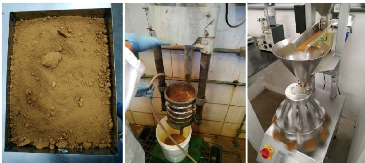
Figura 1. Amostra Limonita C: após secagem (esquerda), classificação granulométrica (centro), e quarteamento (direita).
