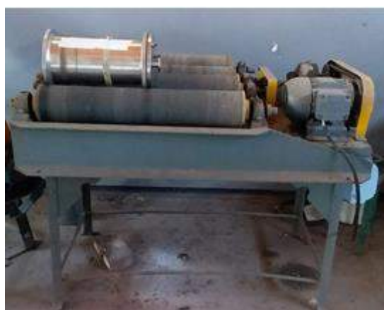
Figura 4. Moinho teste em aço inox.
