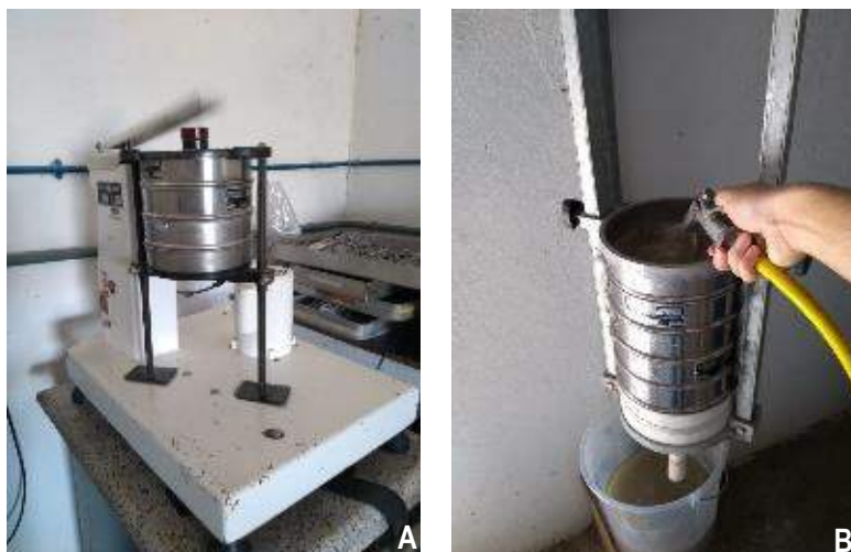
Figura 2. Peneiramento da amostra à seco (A) e a úmido (B).
