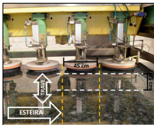
Figura 1. Esquema da cinemática do processo industrial.
