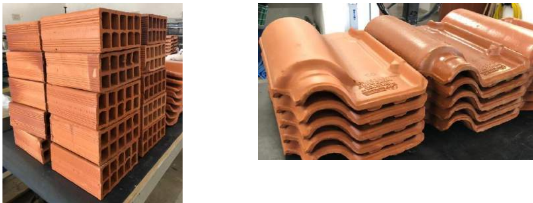
Figura 2. Blocos de vedação e telhas coletados nas empresas para a realização de ensaios.
