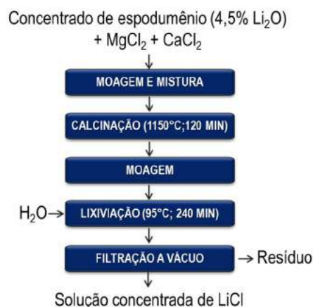
Figura 1. Diagrama de blocos dos ensaios preliminares.
